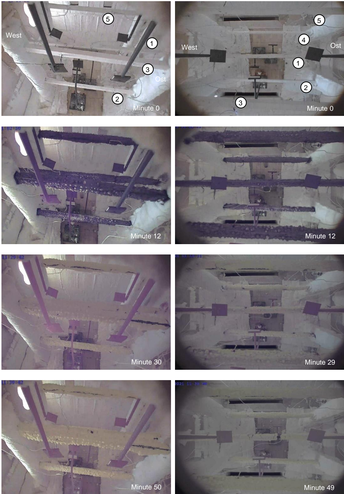
Abbildung 24: Brandversuch TP-A mit RBS-II, Aufnahmen aus dem Brandversuch Links: Aufnahmen von seitlich oben; Rechts: Aufnahmen von oben
