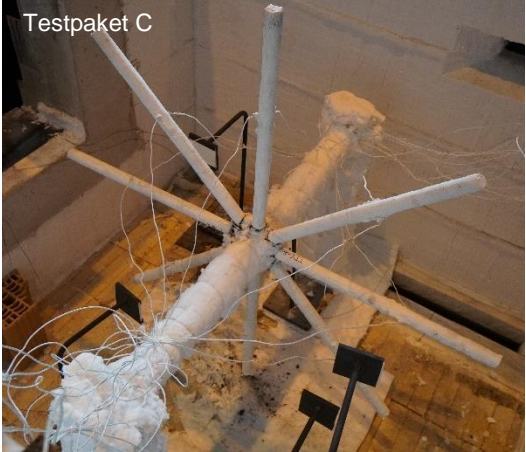
Abbildung 27: Blick auf die Probekörper mit RBS-I vor und nach dem Brandversuch
