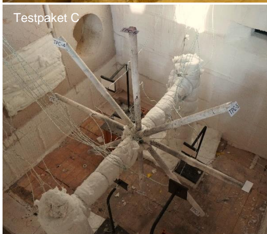
Abbildung 28: Blick auf die Probekörper mit RBS-II vor und nach dem Brandversuch
