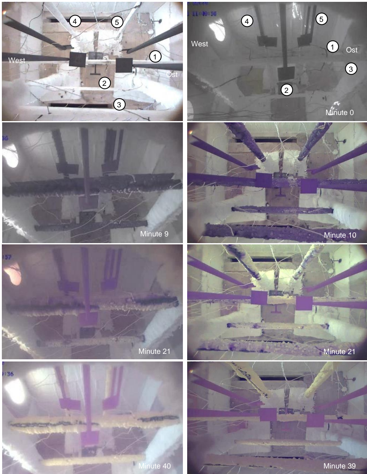
Abbildung 25: Brandversuch TP-B mit RBS-II, Aufnahmen aus dem Brandversuch Links: Aufnahmen von seitlich oben; Rechts: Aufnahmen von oben
