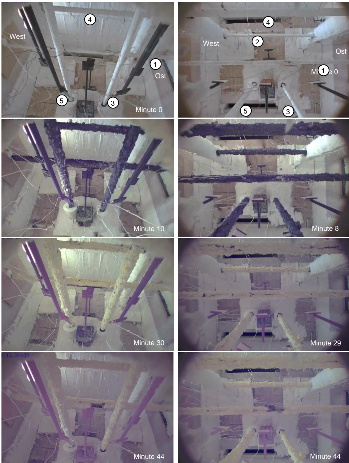
Abbildung 22: Brandversuch TP-B mit RBS-I, Aufnahmen aus dem Brandversuch. Links: Aufnahmen von seitlich oben; Rechts: Aufnahmen von oben
