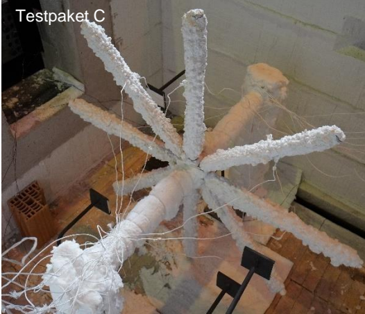
Abbildung 27: Blick auf die Probekörper mit RBS-I vor und nach dem Brandversuch
