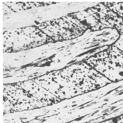
Abb. 12 Adhäsiver Übertrag von \text{TiO}_2 auf \text{Al}_2\text{O}_3 nach 30minütigem Versuch bei 400^\circ\text{C} ( v = 26,4 \text{ cm/s} und p = 2,54 \text{ bar} ) [35]. X80
