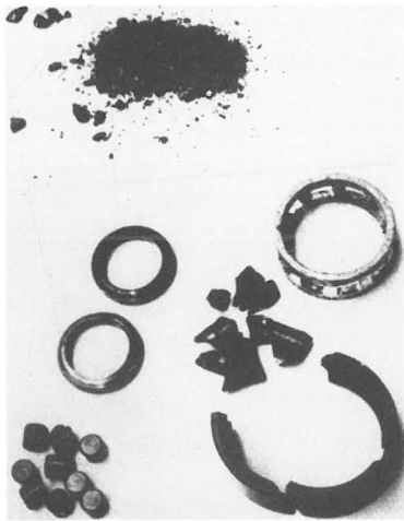
Abb. 4 Katastrophales Versagen eines Keramik-Kugellagers [25]
