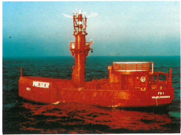
Abb. 3 Feuerschiff Weser mit rot lumineszierendem Anstrich
