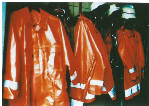
Abb. 7 Rot lumineszierende Schutzkleidung und langnachleuchtende Schutzhelme bei der Feuerwehr
