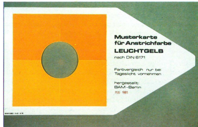
Abb. 10 Lumineszierende BAM-Grenzmusterkarte nach G. Döring (BAM 5.43)
