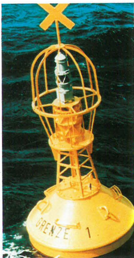
Abb. 1 Tonne mit gelb lumineszierendem Anstrich
