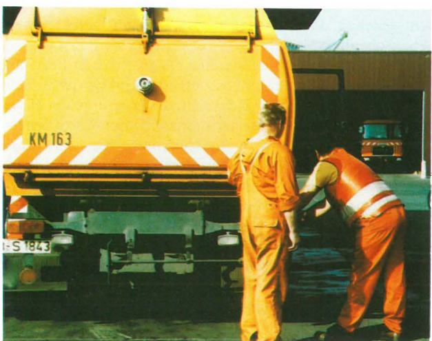
Abb. 6 Sicherheitskennzeichnung an einem Fahrzeug, orangefarbene Warnkleidung und Warnwesten bei der Straßenreinigung
