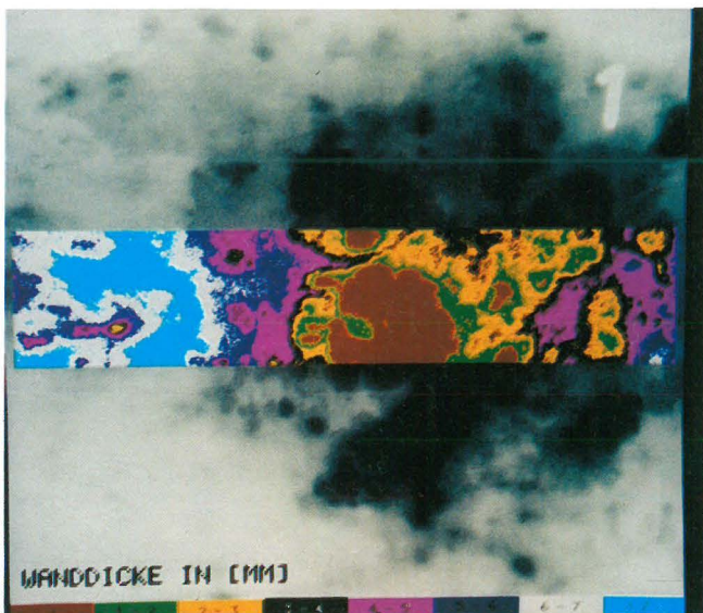
Abb. 3.3 Farbmarkierung von Wanddickenbereichen mittels digitaler Bildverarbeitung
