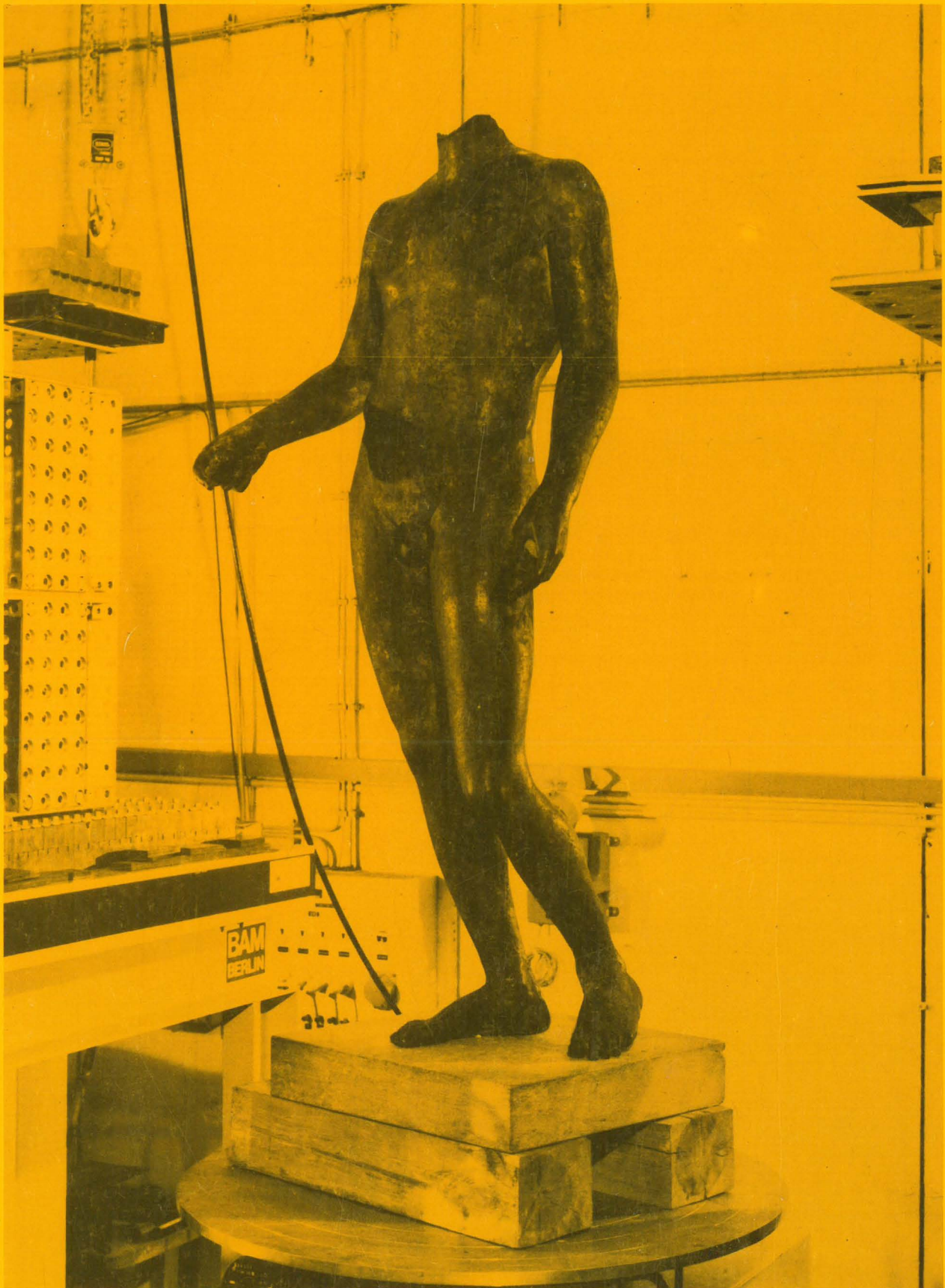
Zerstörungsfreie Prüfung archäologischer Bronzen mit Computertomographie Das Bild zeigt den Jüngling von Salamis (Höhe 1,21 m, Antikenmuseum Berlin SMPK) auf dem in der BAM für Materialprüfzwecke entwickelten Computertomograph mit Röntgen- und Gammastrahlen. Problemstellung: Aufbau, Wanddickenbestimmung, Lötstellen
