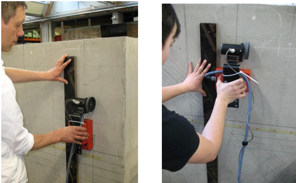
Abbildung 51 Handmessung entlang eines Bewehrungsstabes zur Überprüfung der automatisierten Scannermessungen; Antennenorientierung 0° (links) und 90° (rechts)
