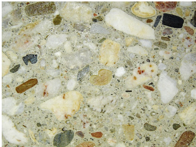
Abbildung 8 Schnittfläche eines gesägten Betonprismas, Quarzkies umgeben mit Zementstein (Quelle www.euroquarz.de )
