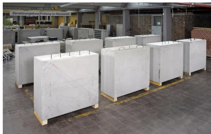
Abbildung 15 Beton Probekörper mit Varianten in der Gesteinskörnung, Bewehrungsdurchmesser und Einbautiefe der Bewehrung
