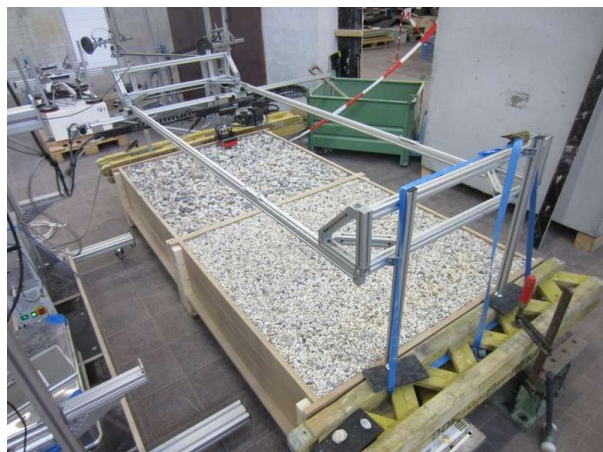
Abbildung 58 Versuchsaufbau mit Bauwerksscanner und den zwei unterschiedlichen Schüttungen aus Quarzkies
