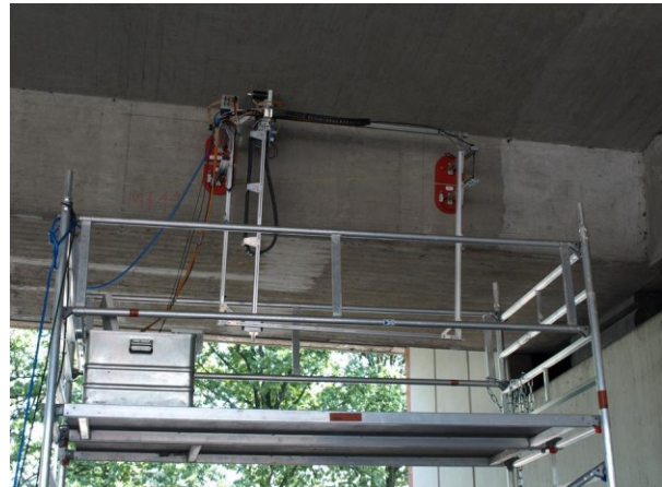
Abbildung 13 Bauwerkscanner mit Vakuum-Füßen für die Untersuchung einer Hohlkastenunterseite
