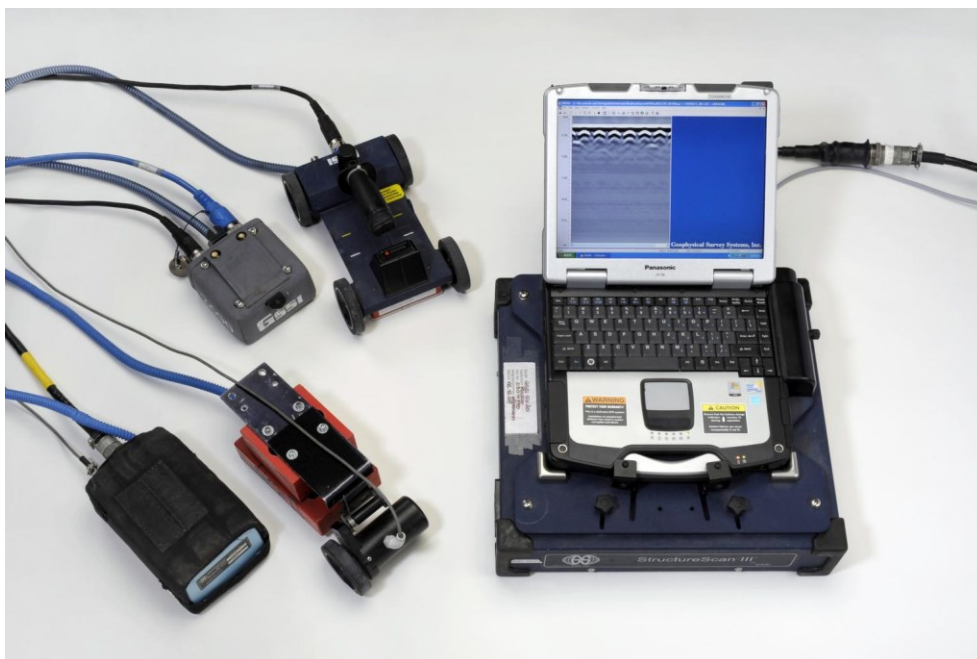
Abbildung 16 Radarsystem SIR 20 (rechts) der Fa. GSSI mit 1,5 GHz (vorne links) und 2,6 GHz Antenne (hinten links)
