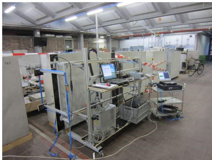
Abbildung 14 Bauwerksscanner zur automatischen Führung eines Messkopfes entlang einer Bauelementoberfläche, wie er in dieser Arbeit verwendet wurde
