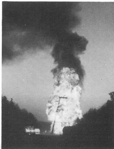
Abb. 1 Feuerball nach Bersten eines Propan-Lagertanks; Zeit zwischen den Bildern: 1 Sekunde; die größte Höhe des Feuerballs betrug ca. 120 m (Versuch I.5/399)
