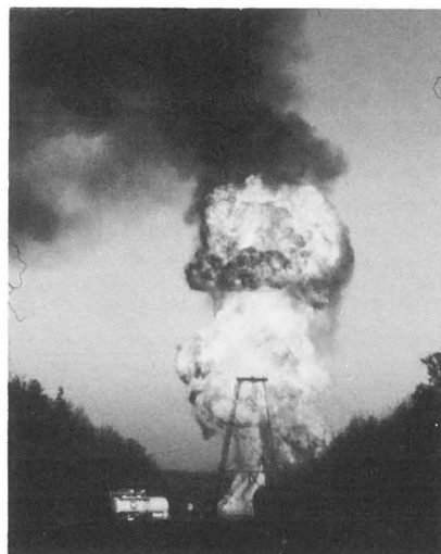
Abb. 1 Feuerball nach Bersten eines Propan-Lagertanks; Zeit zwischen den Bildern: 1 Sekunde; die größte Höhe des Feuerballs betrug ca. 120 m (Versuch I.5/399)
