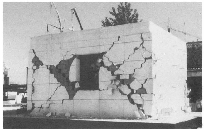
Abb. 8 Dörfliches Haus aus Anatolien nach einer simulierten Erdbebenbeanspruchung
