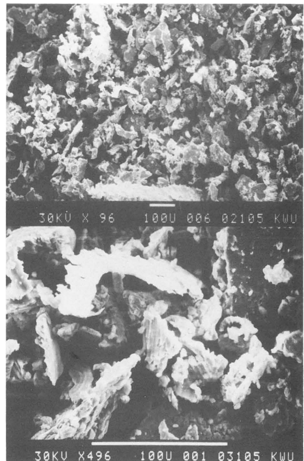
Abb. 2 Zircaloy-Späne aus bestrahlten Brennstabhüllen (REM-Aufnahme)
