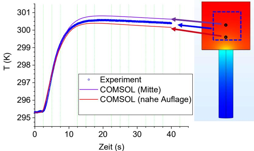
Berücksichtigung der Wärmeverluste durch Auflage führt zu einer starken Ortsabhängigkeit des Temperaturverlaufs
