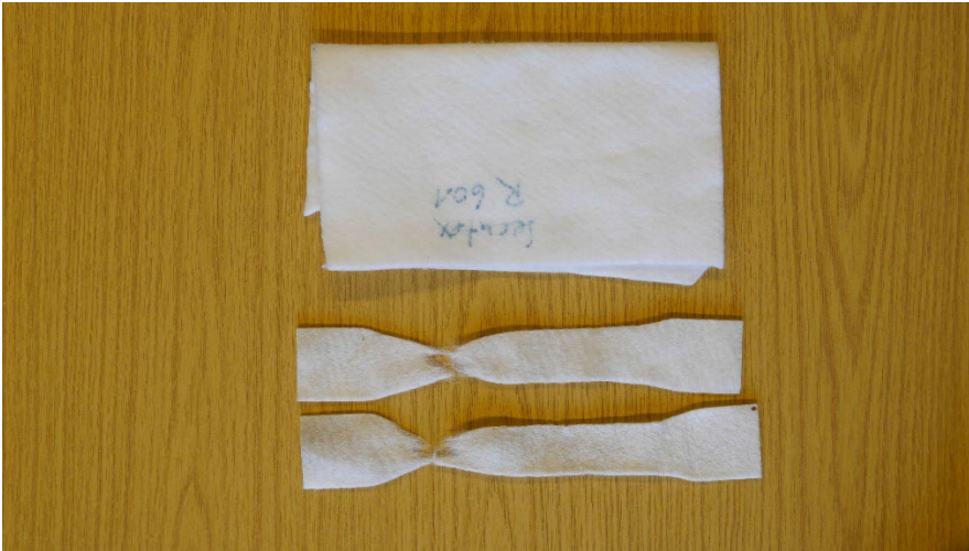
Abbildung 2. Probenmaterial und Proben nach dem Zugversuch
