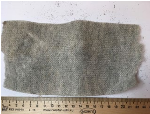
Abbildung 5. Fotos von gesammelten Objekten während der Feldstudie, a. + b. gealterte Beschichtung von Gabionkäfigen, c. Rest von Geozellen, d. Abfälle von zerrissenen Big Bags.
