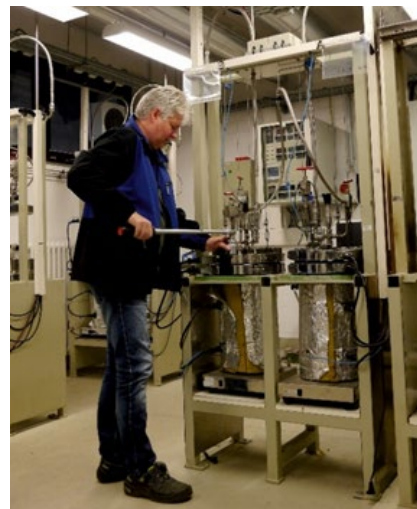
Abbildung 1. Schematische Ansicht der Autoklaven (links), Schließen des Deckels im Autoklaventeststand mit zwei Autoklaven.
