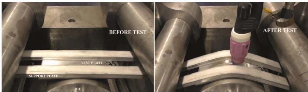
Abbildung 2.12: Varestraint Probe mit aufgelegten Support-Blechen in einer Prüfanlage der Variante B, vor der Prüfung (links) sowie nach erfolgter Prüfung (rechts) [72]
