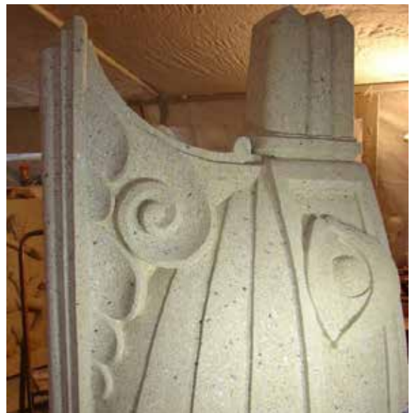
Abb. 7: Einsatz von Steinmetztechniken: Spitzen, Bossieren, Scharrieren, Schleifen zur Erzielung der Natursteinanmutung.
