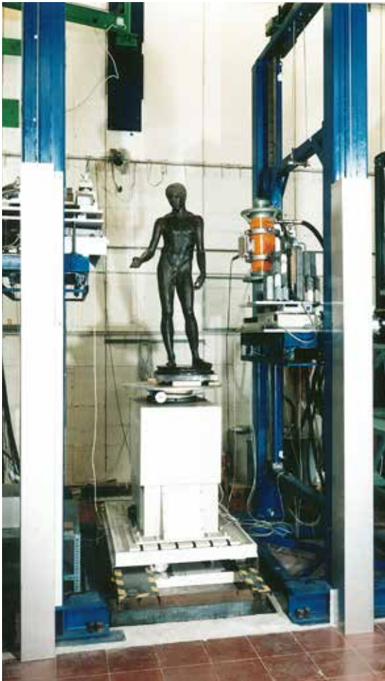
Abb. 2.3: Der Idolino auf dem Messplatz für Computertomographie der BAM.
