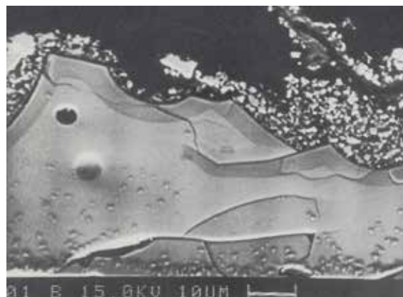
Abb. 5.4: Mikrorisse in einem blaugrünem Transluzidemal (Aufnahme mit polarisiertem Licht, 50fache Vergrößerung, oben). Der Querschnitt durch einen Emailsplinter zeigt, dass alkali-verarmte Gelschichten größtenteils mit Rissbildungen korrelieren (REM-Aufnahme, unten).
