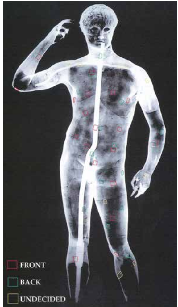
Abb. 2.4: Das Radiographiebild macht die Stützstruktur der Getty-Bronze sichtbar. Farblich umrandet sind die Stellen, die eine größere Wanddicke aufweisen.
