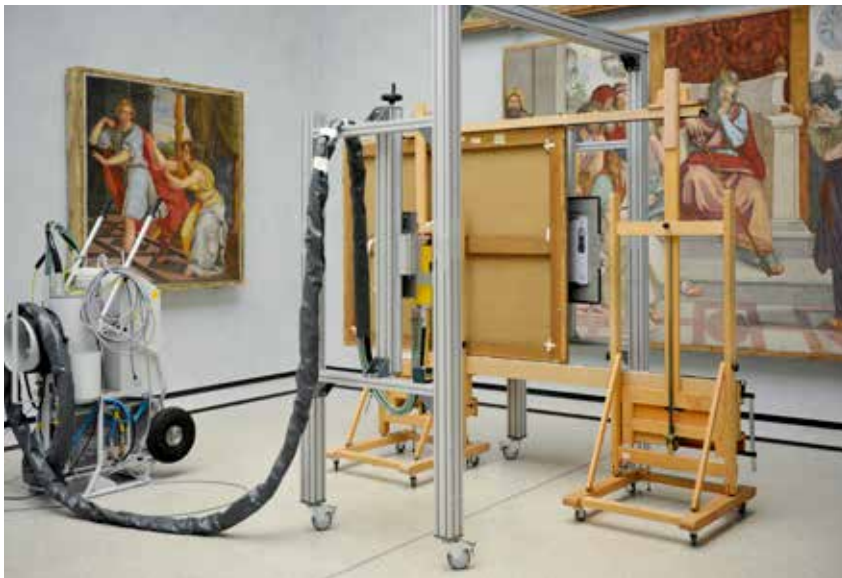
Abb. 1: Vorbereitung eines Gemäldes für die Radiographie.
