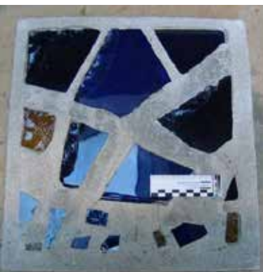
Abb. 8g: Entfernen der Schutzfolien von den Dickgläsern und abschließende Reinigung der Dickgläser.
