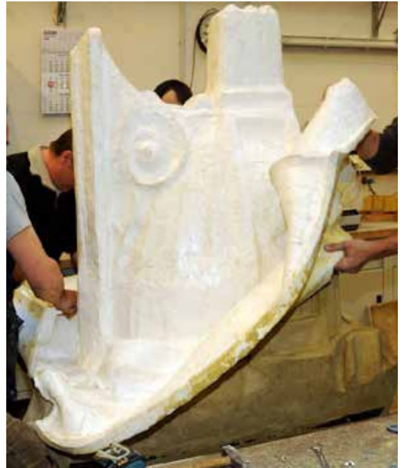
Abb. 6: a) Abguss der Einzelelemente in GFK 11 -verstärkten Silikonformen, die über Gipsmodelle hergestellt wurden. b) Entformen durch Abziehen der Silikonform nach Demontage der GFK-Tragschale.
