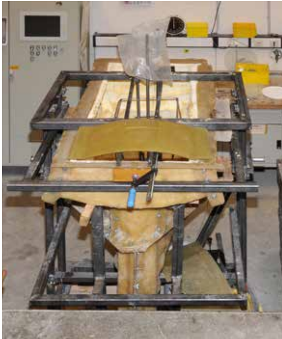
Abb. 6: a) Abguss der Einzelelemente in GFK 11 -verstärkten Silikonformen, die über Gipsmodelle hergestellt wurden. b) Entformen durch Abziehen der Silikonform nach Demontage der GFK-Tragschale.
