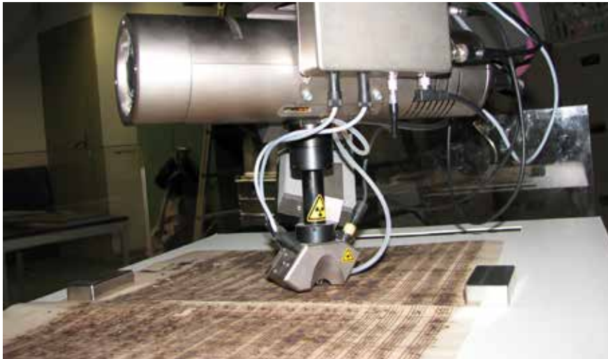
Abb. 3.2: Die Untersuchung der h-Moll-Messe mittels Röntgenfluoreszenzanalyse. Foto: Staatsbibliothek Berlin, SPK, Restaurierungswerkstatt.
