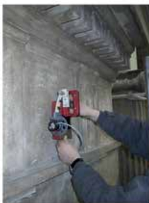
Abb. 2: Messprinzip und praktischer Einsatz des Radarverfahrens in Reflexionsanordnung. Vertikales Verfahren des 1,5 GHz-Antennenpaares (links), Messanordnung (Mitte) und Messergebnis (rechts) mit zylindrischem Detektor in Anlehnung an Daniels 12 .
