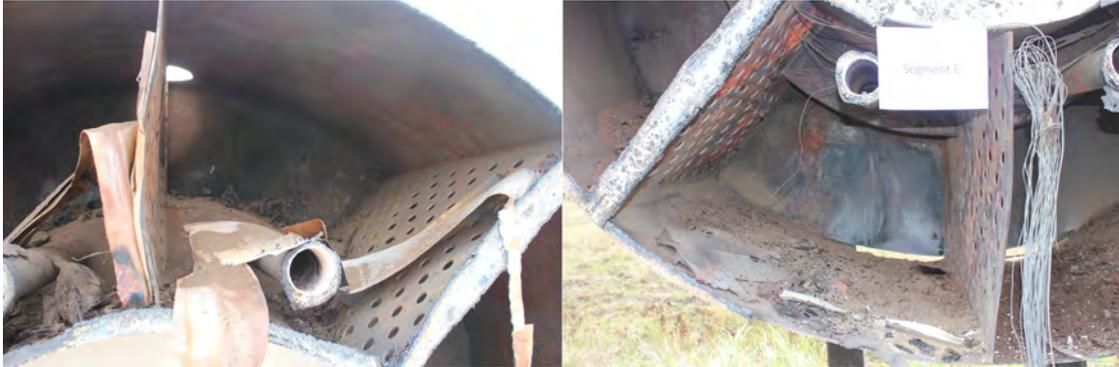
**Abbildung 4.26:** Segment A (links) und Segment E (rechts) nach Versuchsende; der Stoßdämpfer wurde mit einem Plasmaschneidgerät geöffnet
