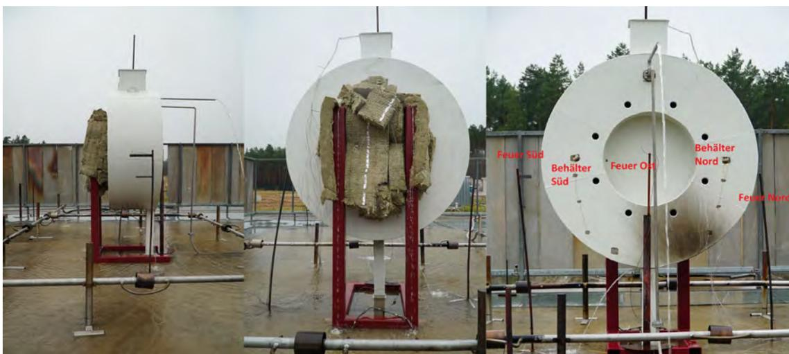
**Abbildung 4.2:** Kalorimetrieversuchsbehälter auf dem Brandprüfstand
