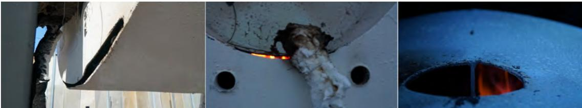
**Abbildung 4.17:** Stoßdämpferbeschädigungen nach der Feuerphase: simulierte aufgeplatzte Schweißnähte (links und mittig), Dornloch (rechts)
