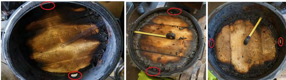
**Abbildung 5.9:** Prüfkörper 1 (links) und 8 (mittig und rechts) nach Brandende
