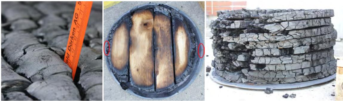
**Abbildung 5.8:** Prüfkörper 2 nach Brandende: äußere verkohlte Schicht (links), Verkohlung des innenliegenden Holzes (mittig), verkohlter Behälterinhalt (rechts) – die Schadstellen sind rot eingekreist
