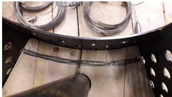
*Abbildung 4.18: Verlegen der Thermoelementleitungen durch gefräste Holzbahnen und Befestigung mit Tackernadeln*
