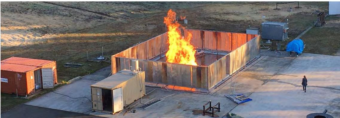
**Abbildung 4.20:** Stoßdämpfergroßbrandversuch auf dem propangasbefeuelten Prüfstand
