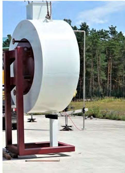
**Abbildung A.1:** Messstange mit Thermoelementen (links) und am Gestell mit EAB montierter Kalorimetrieversuchsbehälter (rechts)
