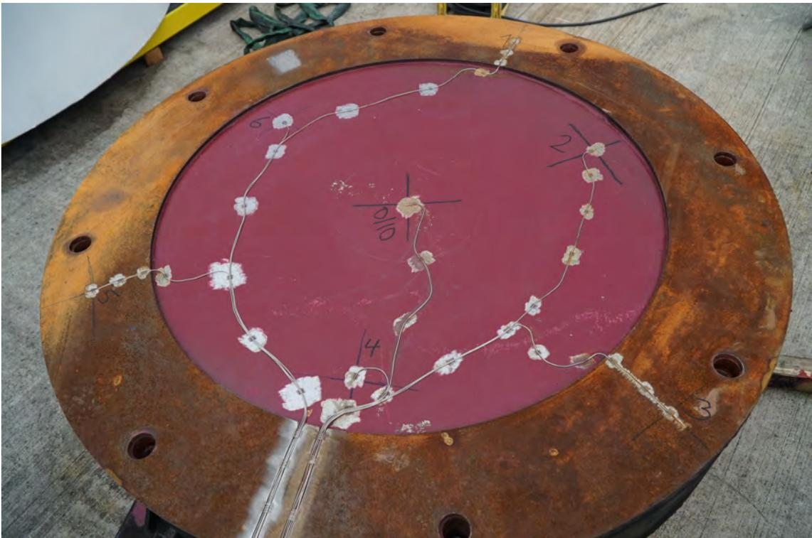
**Abbildung A.6:** Thermoelementverlegung auf dem EAB (die Thermoelemente wurden mit dem Punktschweißgerät auf der Oberfläche fixiert), Zwischenraum EAB - Stoßdämpfer
