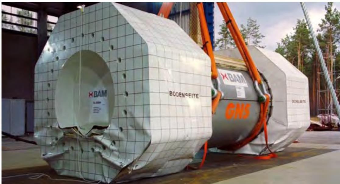
**Abbildung 4.16:** Beschädigungen am CONSTOR-Behälter nach dem 9m-Fall, Aufnahme des Fachbereichs 3.3 (Bundesanstalt für Materialforschung und -prüfung)
