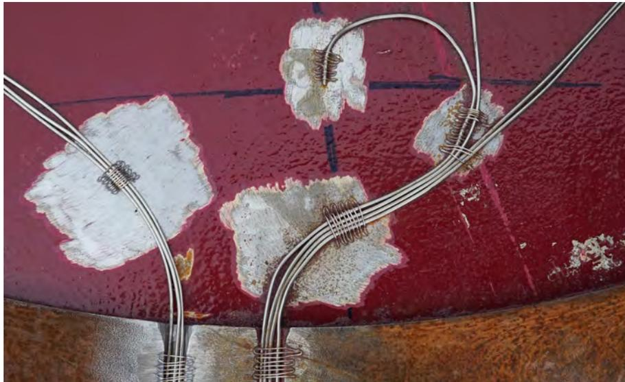
**Abbildung 3.2:** Fixierung von Thermoelementen auf Oberflächen mittels Befestigungsdrähten, welche durch ein Punktschweißgerät angeheftet wurden
