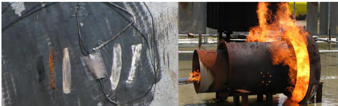
**Abbildung C.2:** Versuchsaufbau zur Oberflächentemperaturmessung: Fixierung der in Abb. C.1 beschriebenen Thermoelemente am Versuchsprobekörper (links) und Versuchsprobekörper (rechts)
