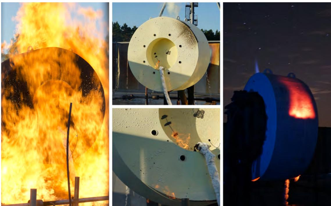
*Abbildung 4.22: Stoßdämpfer während des Brandversuchs: Beflammung des Stoßdämpfers während des Propangasfeuers (links) und Stoßdämpfer nach Einwirkung des äußeren Feuers (mittig und rechts)*
