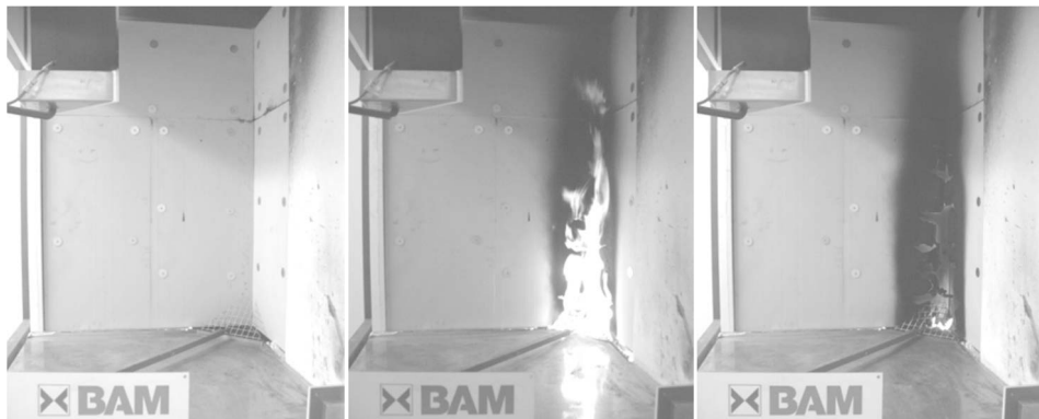
Abbildung 5.5: PUR Hartschaum Proben vor (links), während (Mitte) und am Ende (rechts) der Prüfung im SBI Test.
