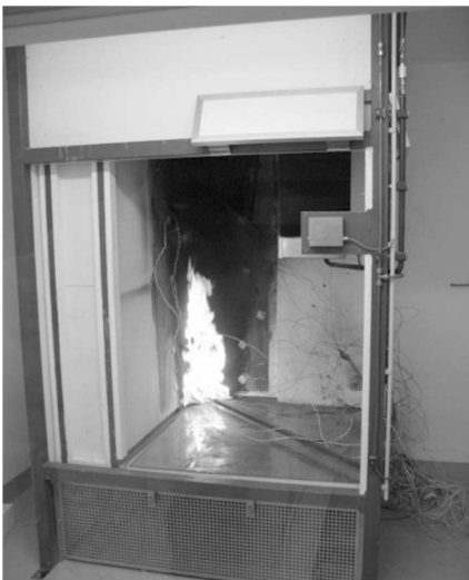
Abbildung 5.1: Bild des SBI Probenwagens mit laufendem Brenner (links) und Nahaufnahme der Diffusionsflamme des Brenners (rechts).
