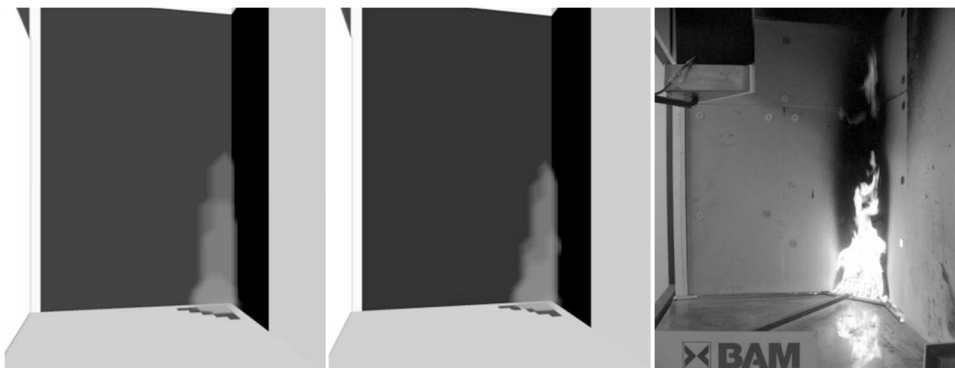
Abbildung 5.23: Aufnahmen der Berechnungen Sim_N2 (links) und Sim_Air (Mitte) sowie das Foto eines Experiments des Werkstoffs PUR (rechts) etwa 300 s nach Anschalten des Brenners.
