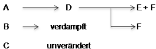
Abbildung 4.7: Reaktionsschema für Brandlasten der Gruppe Holz, mit den Bestandteilen A, B, C, dem Zwischenprodukt D und den Endprodukten E, F.
