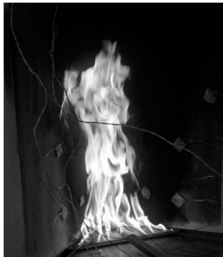
Abbildung 5.1: Bild des SBI Probenwagens mit laufendem Brenner (links) und Nahaufnahme der Diffusionsflamme des Brenners (rechts).
