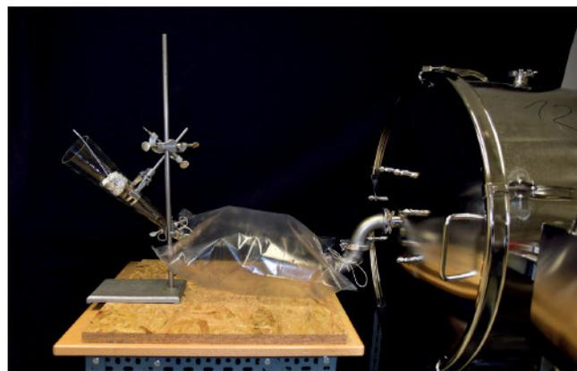
**Bild 4** Tedlaradapter an einer Emissionskammer. Quelle: Simone Brandt
