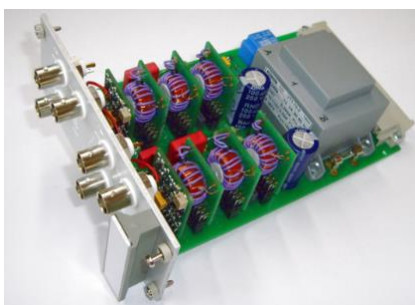
Abbildung 5: Einschub des mehrkanaligen Senders (links) und Blockschaltbild einer Sendestufe (rechts)
