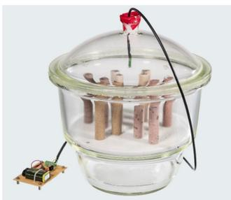
Bild 2: Exsikkator mit Salzlösungen, Proben und Luftfeuchtesensor; Quelle: BAM
