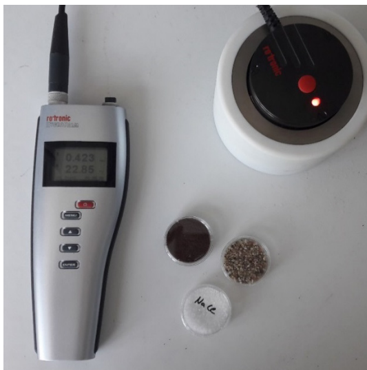
Abbildung 39: HygroPalm23-AW der Firma Rotronic mit temperierbarer Messkammer und Probenschälchen.
