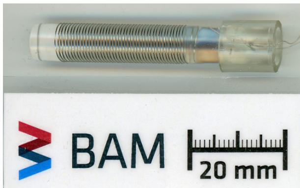
Abbildung 35: Verwendeter coulometrischer Glasstabsensor mit Platinelektroden gewickelt um einen Glasstab, bereitgestellt von der Fa. dr. wernecke Feuchtemesstechnik.
