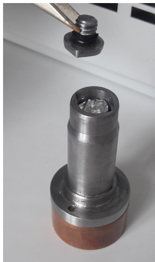
Abbildung 37: Probenbehälter mit Deckel und Aluminiumschälchen für die Probeneinwaage.
