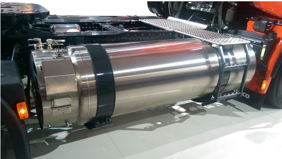
**Bild 2.4:** Iveco Stralis NP mit zwei LNG-Kraftstoffspeichern von 2286 mm Länge und 660 mm Durchmesser.
