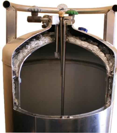
**Bild 2.1:** LNG-Kraftstoffspeicher im Schnitt [61].
