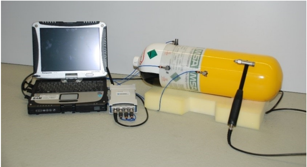
Abbildung 3.18: Aufbau des EMA-Prüfstandes
