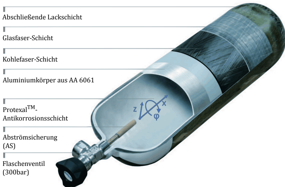
Abbildung 2.1: Schematischer Aufbau eines Typ III-Atemluftbehälters [Dra14, Koordinatensystem hinzugefügt, Beschriftung vergrößert]
