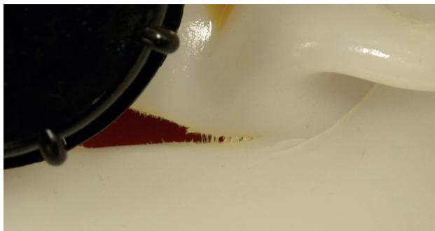
**Abbildung 4.24:** Spannungsriß bei der Stapeldruckprüfung, Kanister aus Material C, 202 d nach Versuchsbeginn
