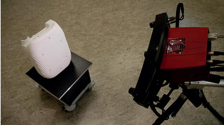
**Abbildung 3.2:** Vermessung einer Kanisterhälfte mittels Streifenprojektionsverfahren, siehe [89]
