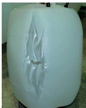
(a) Versagen an der Mitte der vertikalen Kante
