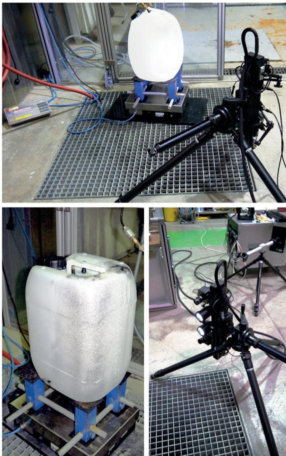
Abbildung 3.4: Aufbau beim Messen mit dem Stereo-Bildkorrelationsverfahren
