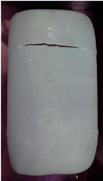
(a) Charakteristische Bruchfläche – Kanister hergestellt aus Material B (gleiches Verhalten für Kanister aus Material A, C)
