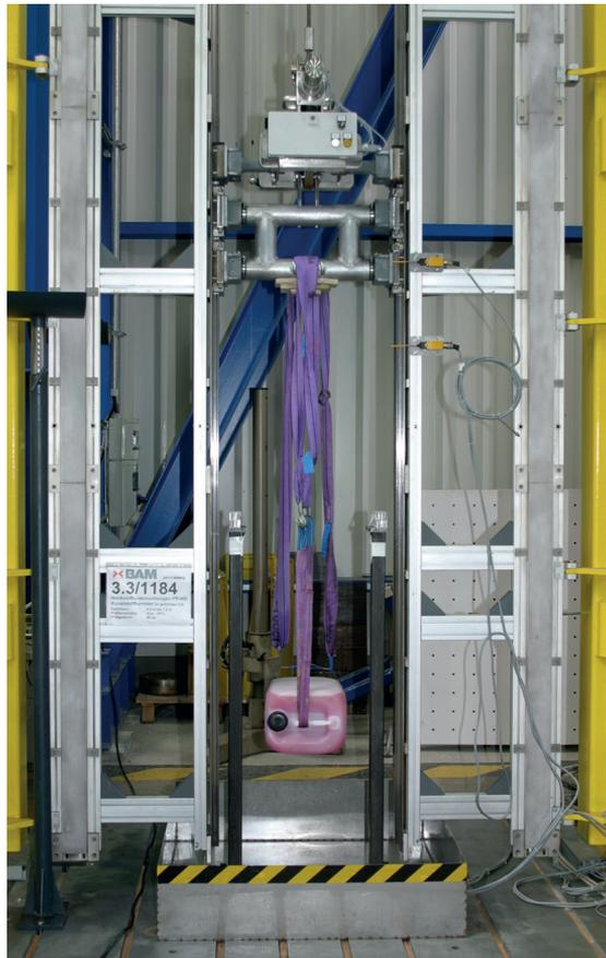
**Abbildung 3.6:** Ausgerichteter Kanister mit Zuggeschirr und Führungswagen im Fallprüfstand
