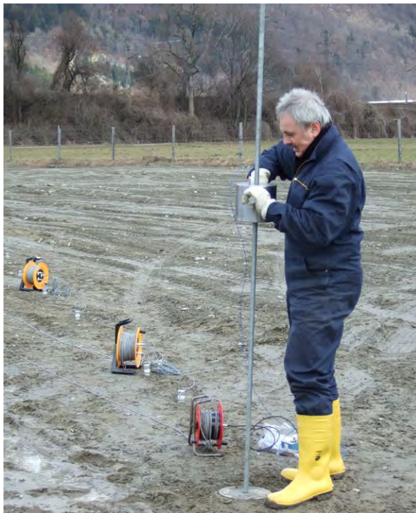
Messung von Zegerschütterungen und Bodenkennwerten mit dem Vielkanal-Messsystem an der Inntal-Zulaufstrecke zum Brenner-Basistunnel
