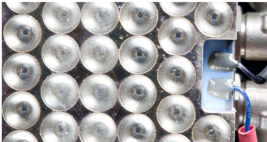
OctoLED – Strahlungsquelle für den Laboreinsatz OctoLED – radiation source for laboratory use
