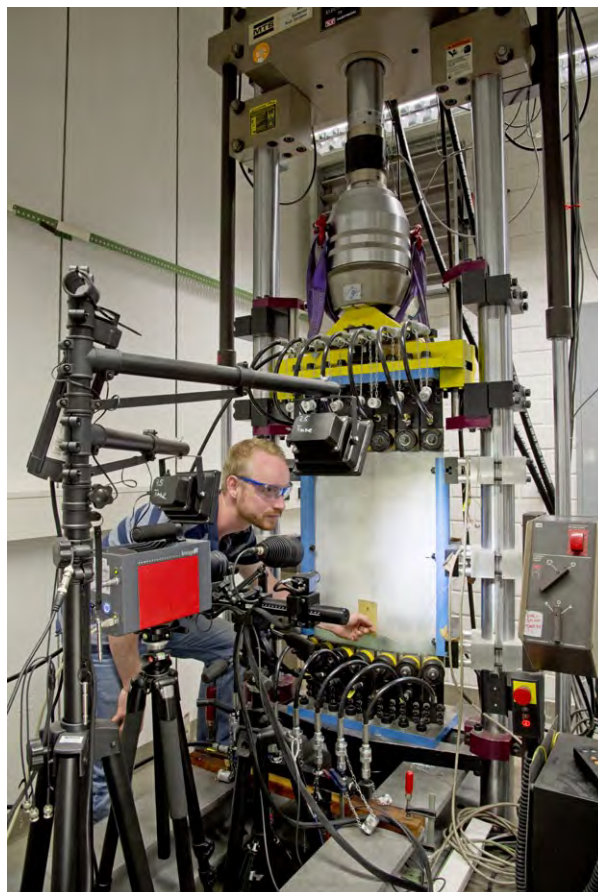
Dustin Nielow am neuen Prüfstand zur Untersuchung der Betriebsfestigkeiten an Faserverbund-Schalensegmenten für Rotorblätter von Windkraftanlagen Dustin Nielow studies the fatigue resistance on fibre composites shell segments for rotor blades of wind turbines in the new test rig
