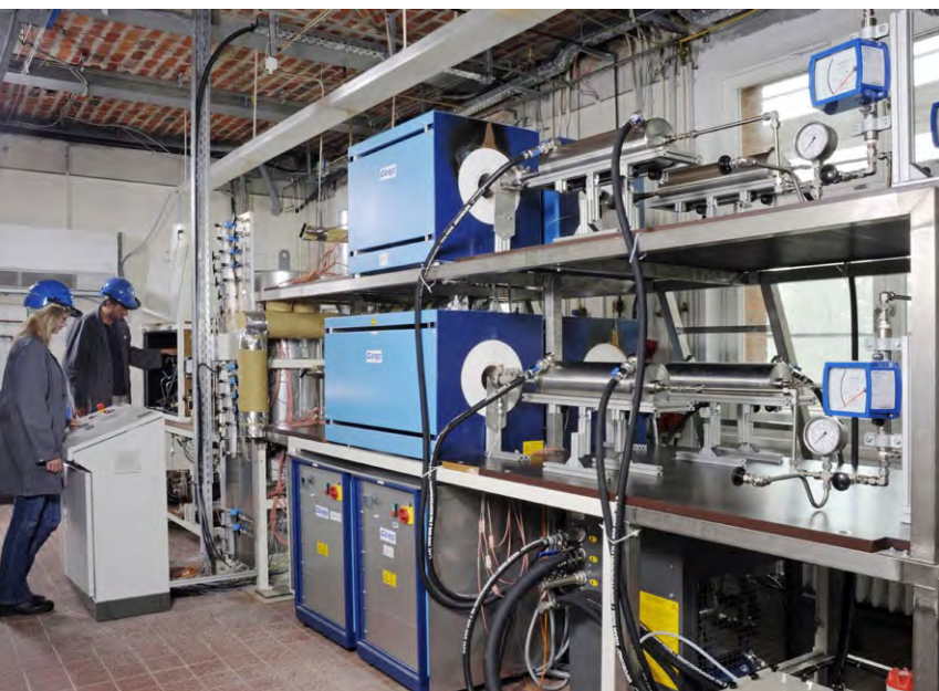
Anlage zur Korrosionsprüfung von Kraftwerksrohren Corrosion testing equipment for power plant pipes
