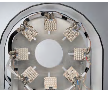
OctoLED – Strahlungsquelle für den Laboreinsatz OctoLED – radiation source for laboratory use
