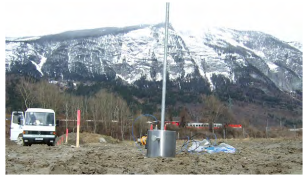
Messung von Zegerschütterungen und Bodenkennwerten mit dem Vielkanal-Messsystem an der Inntal-Zulaufstrecke zum Brenner-Basistunnel
