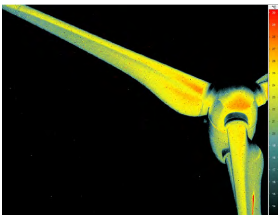
Thermogramm eines sich drehenden Rotorblattes, aufgenommen bei Sonnenschein, die roten Bereiche sind auf die reflektierte Sonneneinstrahlung zurückzuführen. Thermogram of a rotating rotor blade, photographed in sunshine, the red areas are due to reflected sunlight.
