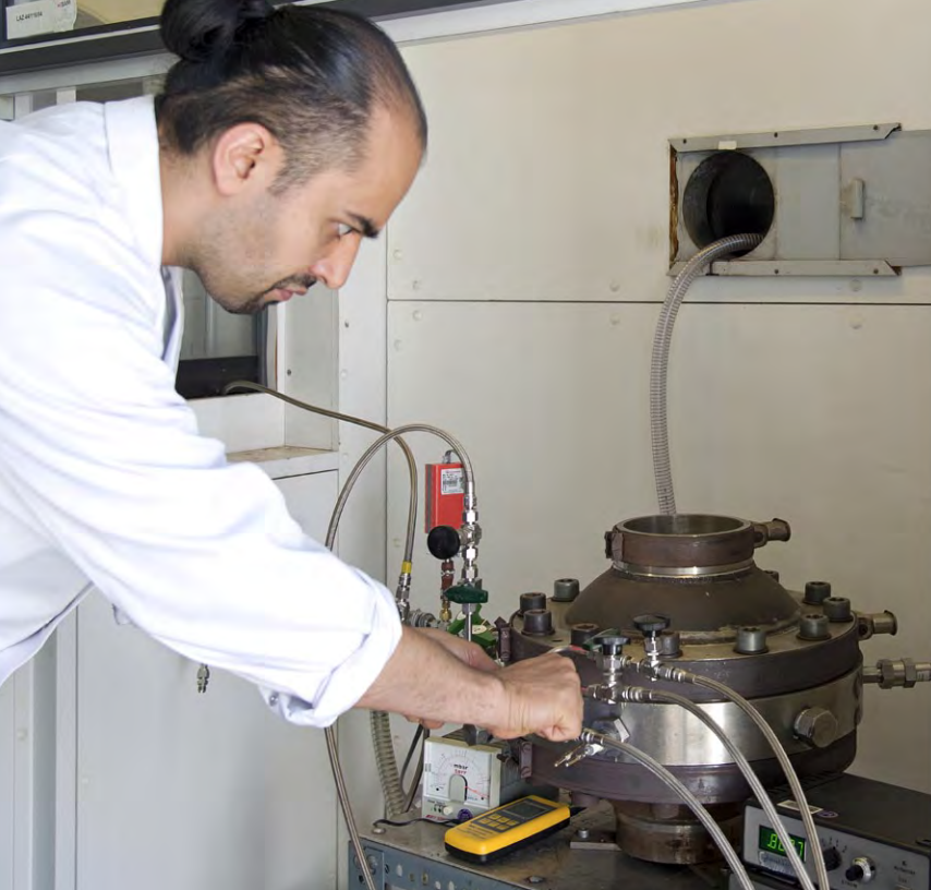
Bombenmethode zur Bestimmung von Explosionsgrenzen, Explosionsdrücken und zeitlichen Explosionsdruckanstiegen von Erdgas-Wasserstoffgemischen
