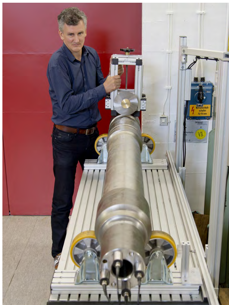
600-kg-Radsatzwelle im Prüfstand 600 kg wheelset axle in the test rig
