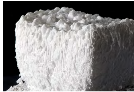
Brandrückstand einer intumeszenten Beschichtung auf Stahl Fire residue of an intumescent coating on steel
