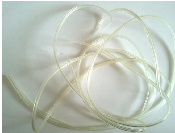
Abbildung 53: Bild eines Polyurethan-Schlauchs
