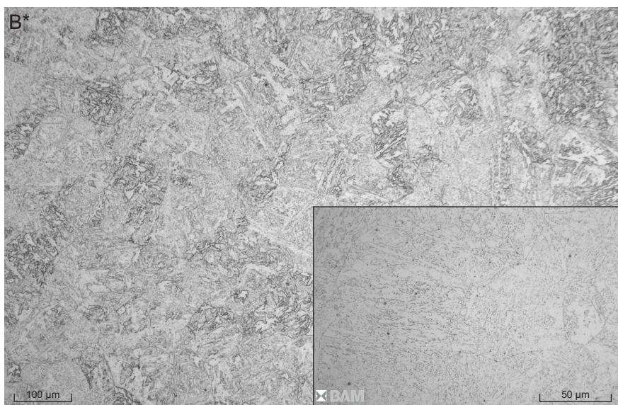
Abbildung 4.36: Übersichts- und Detailaufnahme des überwiegend bainitischen Gefüges, Ofenexperiment mit Abkühlung an Luft, t_{8/5} -Zeit = 111 s
