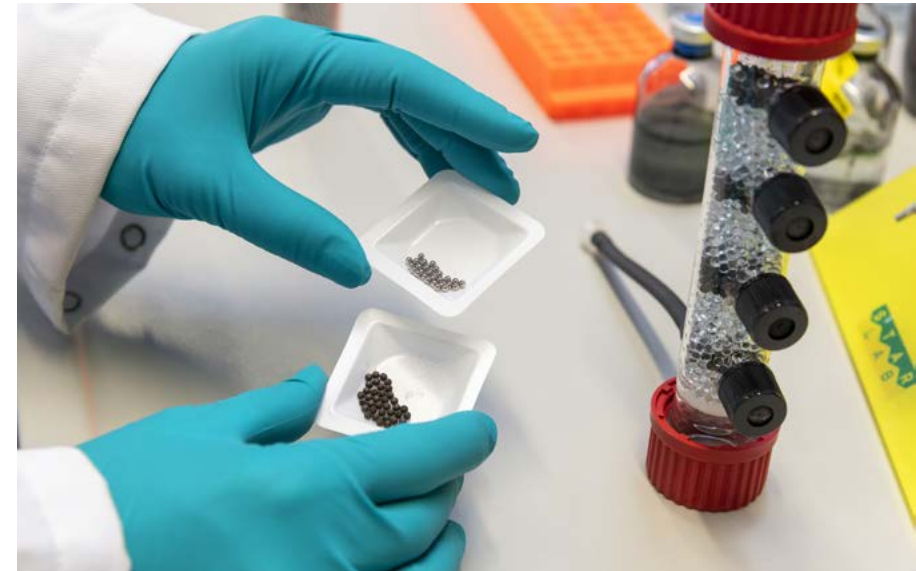
Korrodierte und unkorrodierte Stahlkugeln im Vergleich Corroded and uncorroded steel balls in comparison
