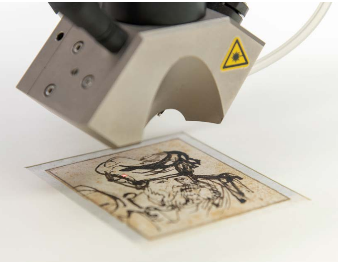
Rembrandt-Zeichnung unter dem Röntgenflu- oreszenzspektrometer
