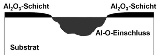
**Abb. 4-57** Schematische Darstellung zum Verhalten eines Al-O-Einschlusses im Stahl nach der Beschichtung und Auslagerung an Luft.
