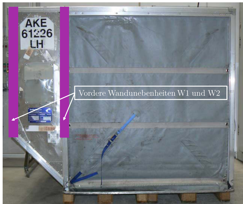
Abbildung 6-6: Oberfläche eines ULD des Typs LD3/AKE und qualitative Positionierung der vorderen Wandunebenheiten W1 und W2
