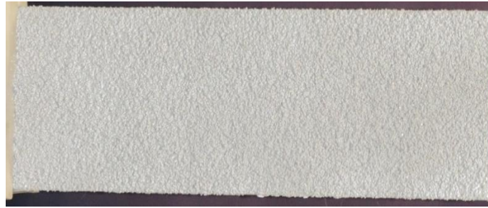
Abb. 7. Polymerbeschichtung auf Stahlsubstrat mit grober Sandeinstreuung (hoher Füllgrad)
