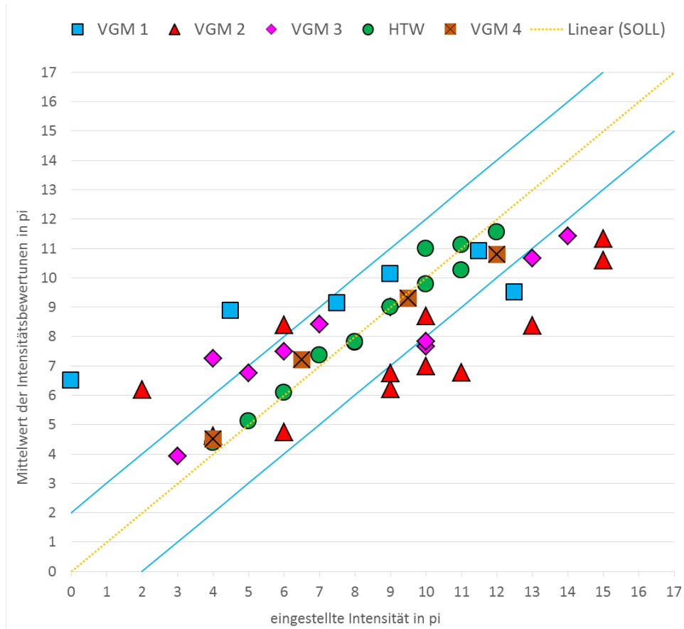
Abbildung 61: Mittelwerte der dargebotenen Acetonkonzentration (aller Vergleichsmaßstäbe) [Quelle: eigene Darstellung, HTW Berlin]
