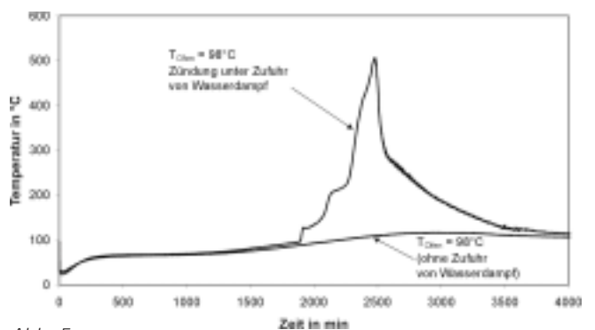
Abb. 5 Temperatur-Zeit-Verläufe von 3200-ml-Braunkohlenstaub-Schüttungen (Fraktion B) bei einer Ofentemperatur von 98 °C, mit und ohne Kondensation von Wasserdampf
