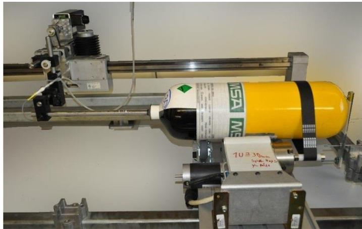
Abbildung 3: Vorrichtung zur Innenprüfung von Composite-Druckgefäßen
