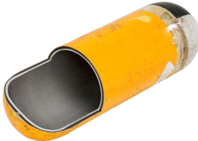
Abbildung 1: Aufbau eines Composite-Druckgefäßes aus einem metallischen Liner (silbern), lasttragendem CFK (schwarz) und schützendem GFK (gelb).
