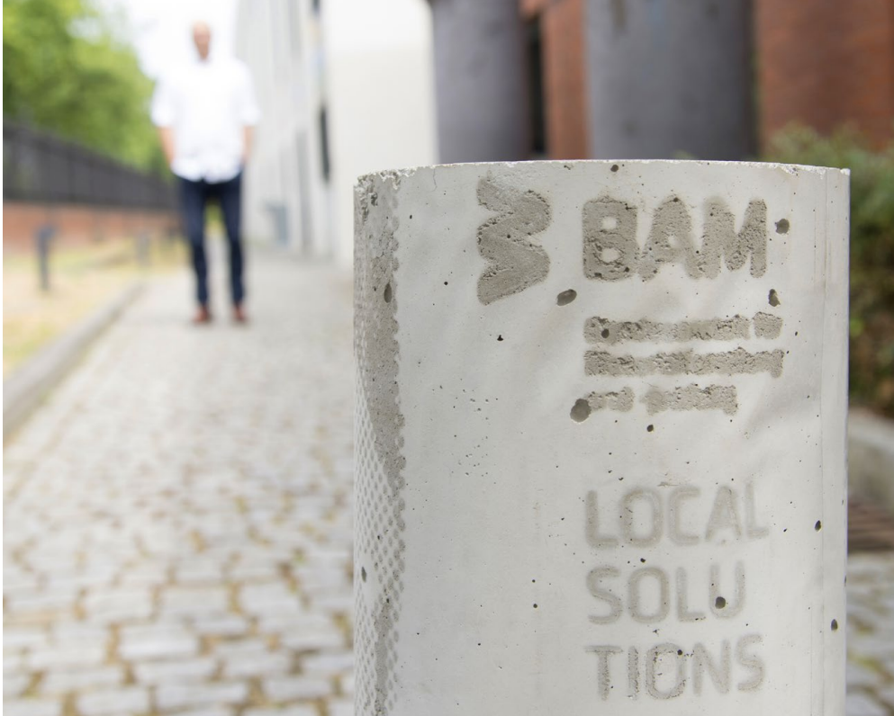
Ansichtsexemplar: Eine Betonsäule mit nachhaltigen Inhaltsstoffen (Cassavaschalen-Asche ersetzt teilweise Zement, Cassava-Stärke verbessert die Verarbeitungseigenschaften.)
