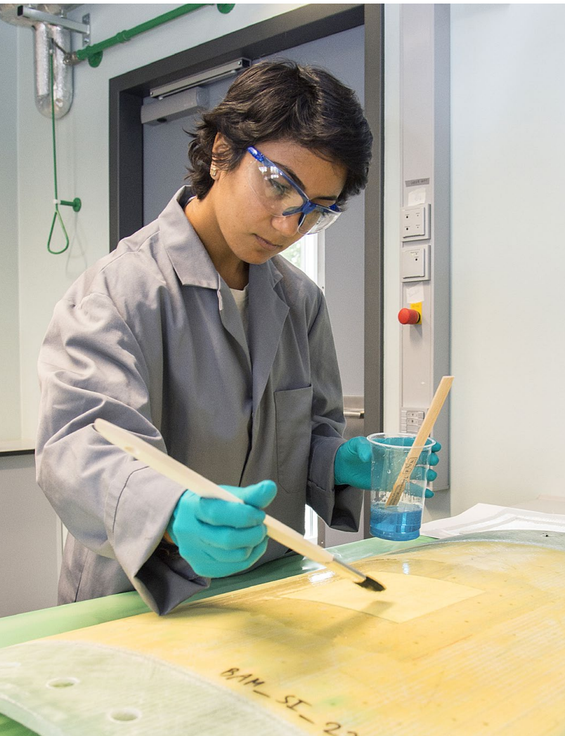
Handarbeit: Reparatur der Schale eines Rotorblatts
