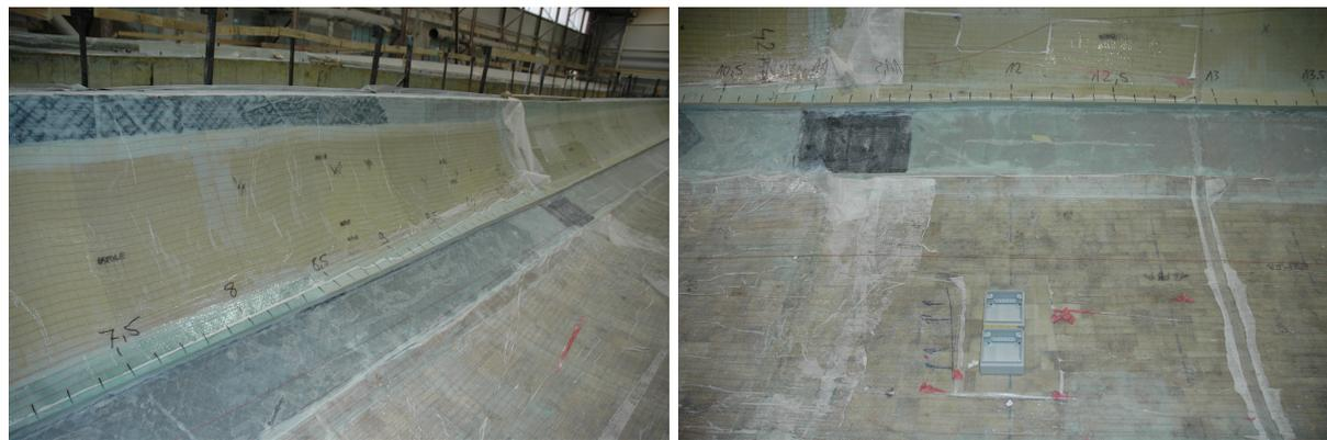
**Abbildung 3.12:** Applikation der strukturintegrierten Fasersensorik in das Original-Rotorblatt; Gurtkanäle als Applikationsort (links) und Herausführung der Fasersensorik aus den Gurtkanälen in Anschlussboxen (rechts)
