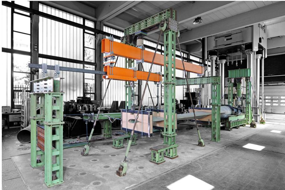
**Abbildung 2.23:** Gesamtansicht des Stellvertreter-Prüfstandes mit dem Lasteinleitungsgestell für die Schlaglast, dem Massenausgleich und dem Lasteinleitungshebel
