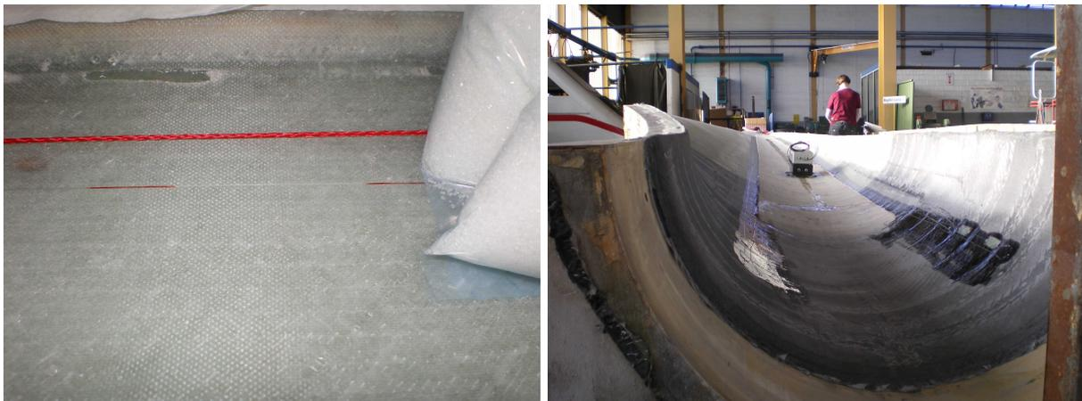
Abbildung 3.15: Ungeschützter FBG-Sensor bei der Applikation (links) und Vorbereitung der Gurtkanäle des Versuchsrotorblattes zur Applikation der Sensorfasern (rechts)
