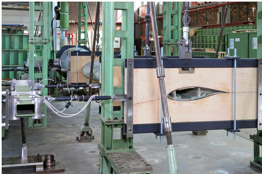
**Abbildung 2.24:** Gesamtansicht des Stellvertreter-Prüfstandes mit den Koppelstangen zur Einleitung der Schlag- und Schwenklast in die Blattschere an der Blattspitze
