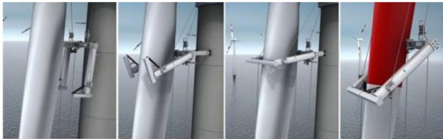
**Abbildung 1.5:** Rotorblatt-Inspektion mit Prüfroboter des Forschungsvorhabens RIWEA
