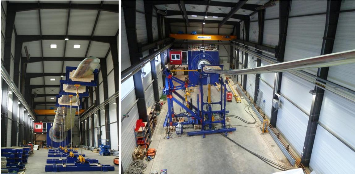
**Abbildung 1.3:** Rotorblatt-Prüfstand des Fraunhofer Instituts für Windenergie und Energiesystemtechnik (IWES) zur Durchführung von statischen Belastungsversuchen und Dauerschwingversuchen durch Resonanzanregung
