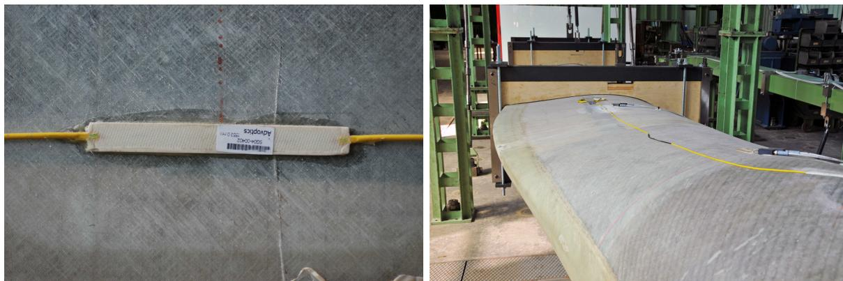
**Abbildung 3.16:** Oberflächenapplizierter FBG-Sensor in Patch-Ausführung (links) und Sensorkette aus FBG-Patches auf der äußeren Blattschale als Ersatz für beschädigte integrierte Sensorkette (rechts)
