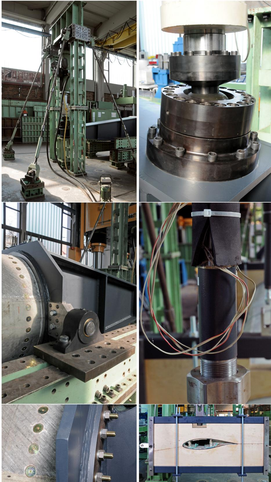
**Abbildung 2.25:** Detailansichten des Stellvertreter-Prüfstandes: Portal des Schlaglast-Zylinders (oben links), Kugelkalotte zur Verbindung des Schlaglast-Zylinders mit dem Gegenhebel (oben rechts), Hauptlager des Gegenhebels (mitte links), Koppelstange mit DMS zur Verbindung der Blattschere mit dem Lasteinleitungsgestell (mitte rechts), IKEA-Anschluß des Rotorblattes an den Gegenhebel (unten links) und Blattschere (unten rechts).
