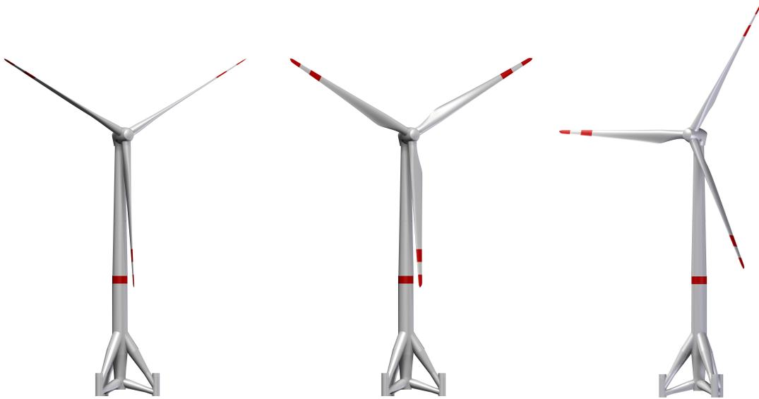
**Abbildung 3.13:** Abgleich der FBG-Sensoren im Originalbauteil bei drei verschiedenen Rotorblattpositionen: Blattspitze zum Boden und Blattvorderkante in Windrichtung positioniert (links), Blattspitze zum Boden und Blattschale in Windrichtung positioniert (mitte), Rotorblatt in horizontaler Ausrichtung und Blattspitze in Windrichtung positioniert (rechts).
