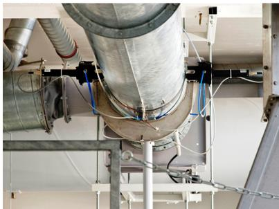
**Abbildung 2.4:** Anordnung der Gaskonzentrationsmesstechnik im Messabschnitt des Abzugsrohres der SBI-Versuchsapparatur (Versuch 3). Bild: Bundesanstalt für Materialforschung und -prüfung (BAM) [24].
