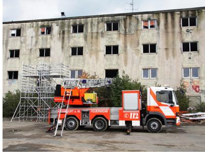
**Abbildung 6.2:** Außenansicht des Gebäudes zur Untersuchung der Brandausbreitung.
