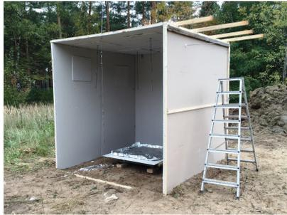
**Abbildung 5.2:** Untersuchungsgeometrie (Versuch 1: Wandöffnung) zur Untersuchung des Einflusses von Ventilationsbedingungen auf die Brandentstehung am Beispiel eines Sessels mit gegenwärtiger stofflicher Zusammensetzung.
