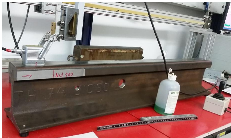
Abb. 1. Messaufbau zur Validierung der Berechnungsergebnisse an einer UIC – 60 Testschiene
