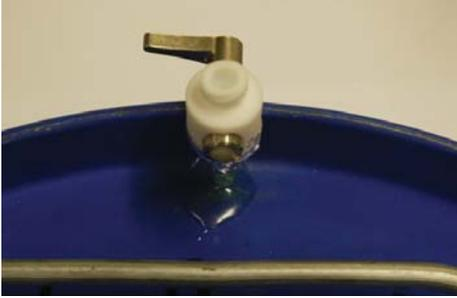
(a) Mit Kanüle und Absperrhahn präpariertes Prüfmuster [65]
