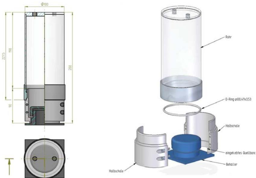
Abb. 4.35: CAD-Modell der 1 L-Akkumulationskammer (BAM)
