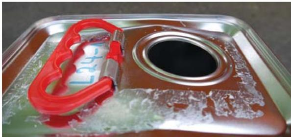
Abb. 6.10: Deformation des Oberbodens bei Überdrücken  $> 300$  mbar, St-6L-Kan [6] [65]
