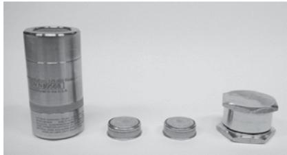
Abb. 4.38: Drucklogger „PR140“, Temperaturlogger „SL52T“ und ihre Edelstahlkapsel [5]
