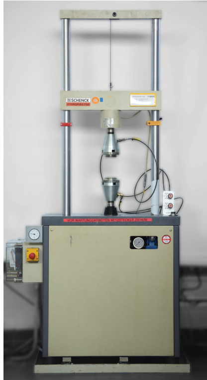
Abbildung A.8: Verwendete servohydraulische Prüfmaschine Schenk Hydropuls PSA
