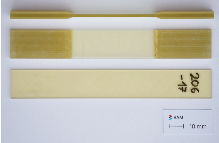
Abbildung A.5: Proben aus GFK-Laminat
