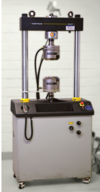
Abbildung A.9: Verwendete servohydraulische Prüfmaschine Instron 8801
