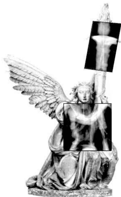
Abb VIII.3-3 Kniender Leuchterengel: Die Radiographie zeigt metallische Armierungen.
