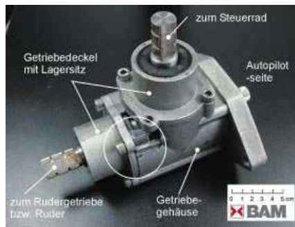
Abb. V.3-3 Umlenkgetriebe mit der schadhaften Schraubenverbindung (geöffnet, im Kreis)
