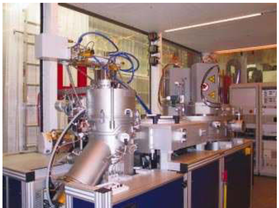
Abb. VIII.0-1 Das neue PVD-CVD Clusterbeschichtungssystem CS 730 ECS
