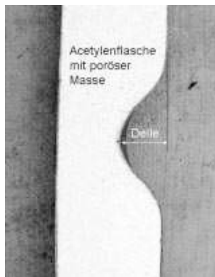
Abb. II.1-1 Querschnitt durch eine Acetylenflasche nach Stoßfestigkeitsprüfung
