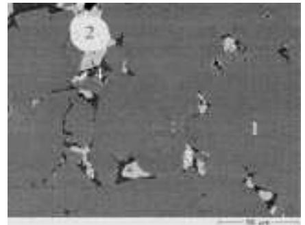
Abb. IV.3-1 Anschnitt eines Ausschnittes aus einem Schmelzprodukt mit 50 % \text{Cr}_2\text{O}_3 im Mischkristall unter dem Lichtmikroskop. 1 Matrix (Chromkorund); 2 metallische Cr-Fe-Phase; 3 Phosphorreiche Phase; 4 Glasphase
