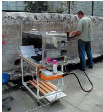
Abb. VII.3-3 Untersuchungen von Spannstählen an einem Spannbetonträger
