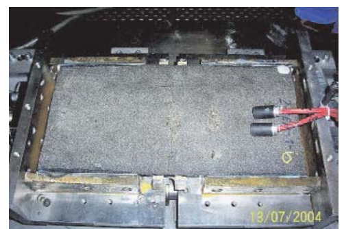
11 Prüfung eines Brückenbelages
