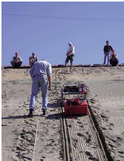
Das SIP-Verfahren im Einsatz auf potenziell rutschungsgefährdetem Hang
