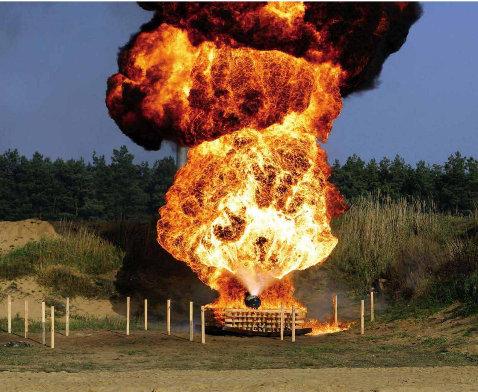
Brandversuch mit einem 60-Liter-Stahlfass, gefüllt mit Benzin
