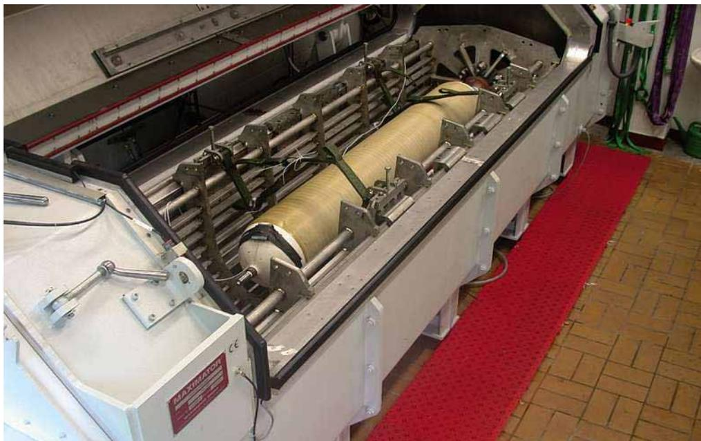
CNG-Speicher Typ II vor Extremtemperatur-Ermüdungsversuch in der Prüfkammer
