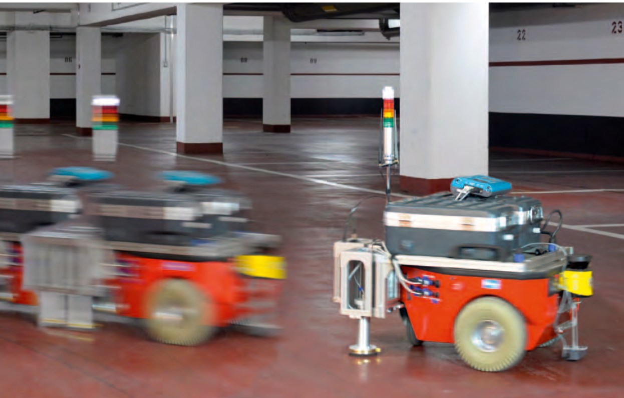
Schnelle automatisierte Zustandsanalyse mit BetoScan
