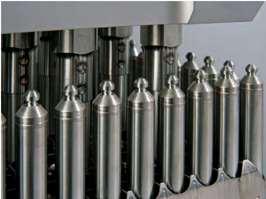
Nachbildung eines Druckwasserreaktor-Brennelements (Uran-Dioxid) mit 16x16 Brennstäben – Detail
