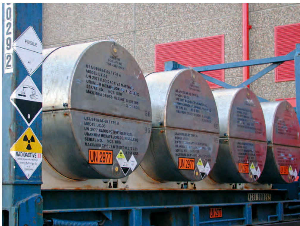
Versandstücke zur Beförderung von UF_6 in 30-B-Zylindern mit Overpacks Quelle: URENCO
