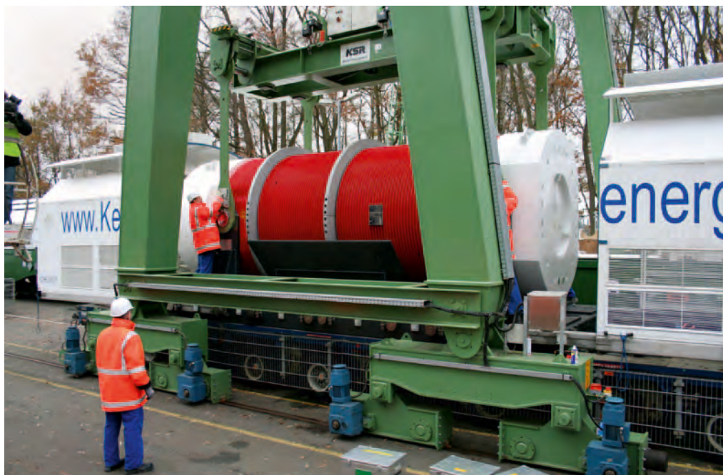
Ein leerer Transport- und Lagerbehälter bei der Erprobung des Umladevorgangs von einem Schienen- auf ein Straßenfahrzeug Foto: GNS
