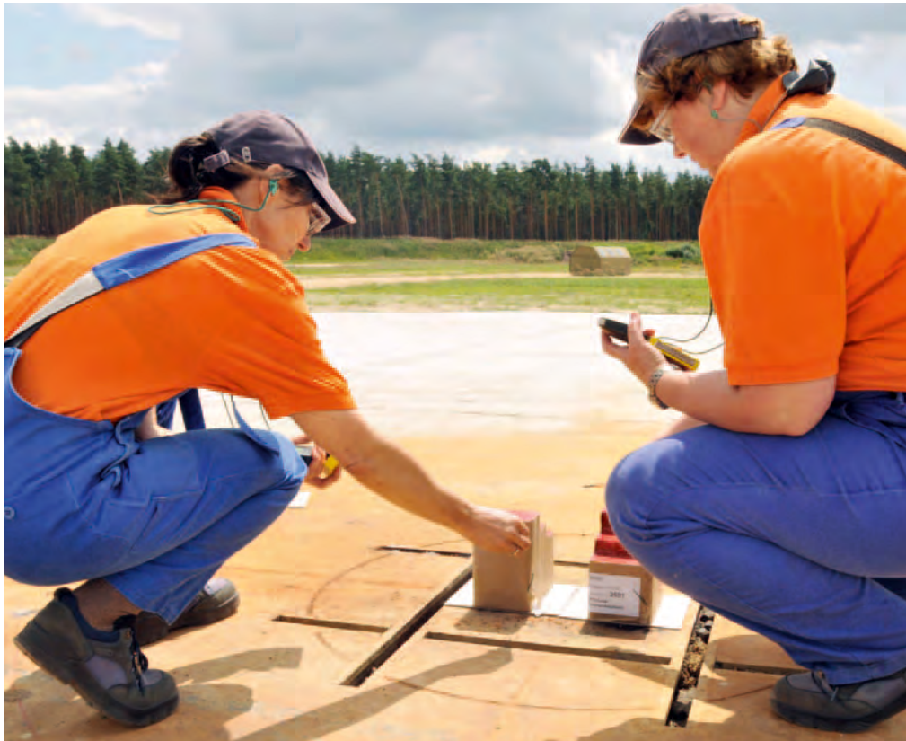
Mitarbeiterinnen der BAM bei der Zulassungsprüfung von Feuerwerkskörpern auf dem BAM Testgelände Technische Sicherheit
