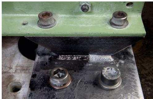
Freigelegte Schweißnaht mit Anriss
