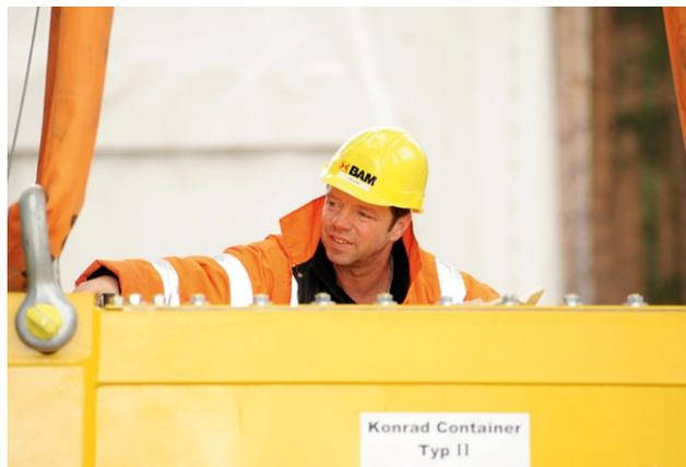
Vorbereiten eines für die Zulassung erforderlichen Fallversuchs mit einem für den Schacht Konrad bestimmten Behälter
