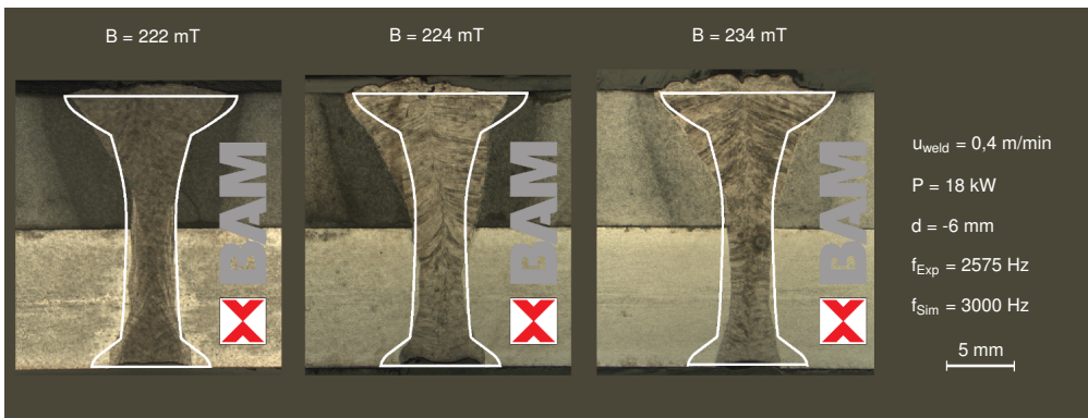
Abbildung 5.15: Vergleich von experimentell ermittelten Querprofilen der Schweißnähte mit elektromagnetischer Unterstützung an 20 mm Stahl AISI 304 und S235JRC mit den Simulationen von AISI 304.
