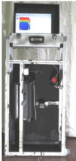
Abb. 7. Geöffneter Prototyp mit Laptop zur Steuerung der Messung und Vorauswertung vor Ort
