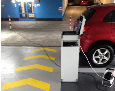
Abb. 1. Parkhaus mit Fußbodenbeschichtung, in der Bildmitte steht der mobile Prototyp zur berührungslosen Schichtdickenmessung
