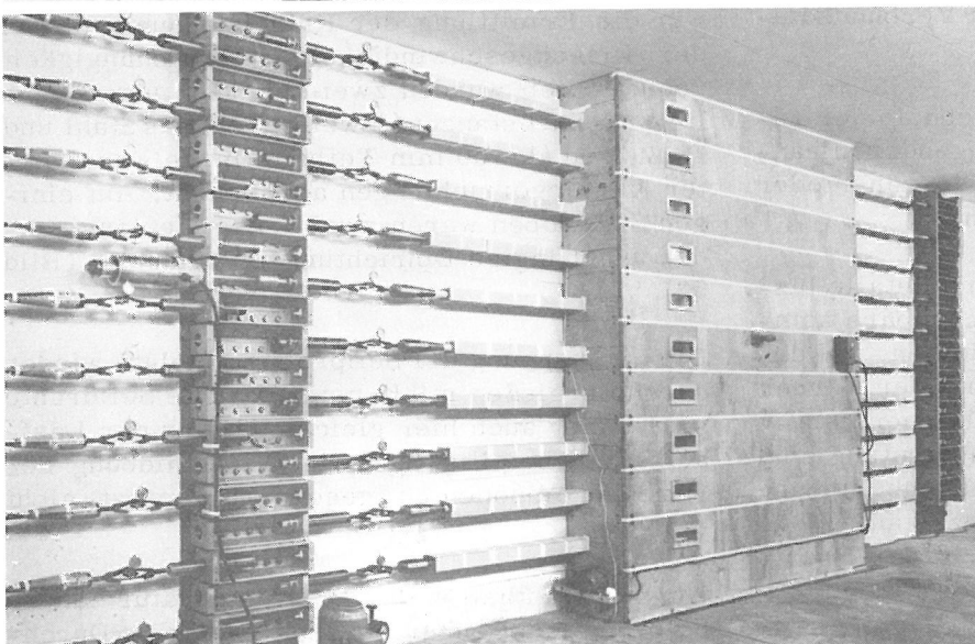
Bild 53 Versuchseinrichtung für Dauerstand- versuche an verseilten Werkstoffen bei erhöhten Temperaturen
