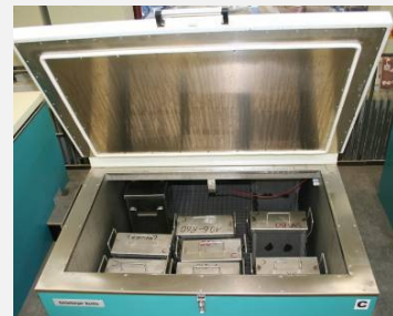
60°C Betonversuch mit externer Alkalizufuhr
