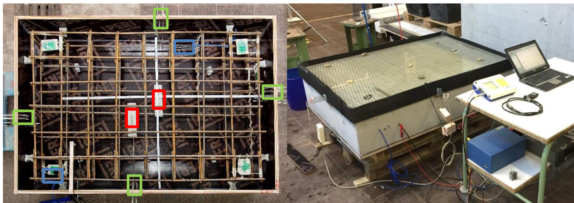
Abb. 1. Korrosionsprobekörper; Links: Draufsicht auf Probekörper mit rot markierten Korrosionselektroden, grün markierten Chloridmigrationssensoren und blau markierten ERE 20 Referenzelektroden vor der Betonage; Rechts: Probekörper mit Salzwasserbad während des potentiostatischen Chlorideintrags.
