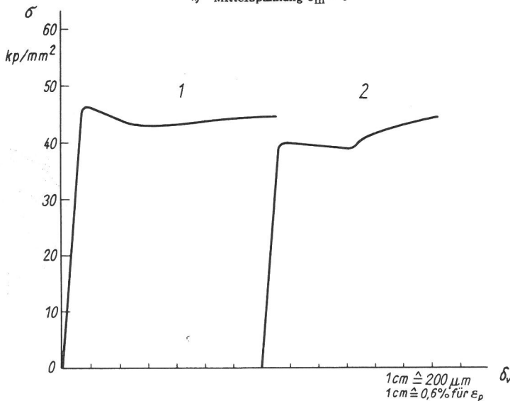
Bild 43 Spannungs-Verformungsweg-Verhalten im Bereich der Streckgrenze St 52-3 Serie 2 mittlerer Korndurchmesser d_K = 13 \mu m Probe 1: ohne vorhergegangene Wechselbeanspruchung Probe 2: nach der Wechselbeanspruchung mit einer Kraftamplitude P_a unterhalb des Grenzwertes für die Erhöhung der Verformungswegamplitude
