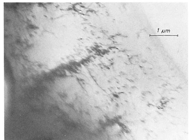
Bild 28 c St 52-3, 2. Serie, \sigma_a = 32,9 \text{ kp/mm}^2 , N = 100
