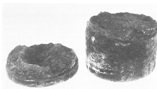
Bild 11 Teile einer porösen Masse aus einer aufgeschnittenen Acetylenflasche, in der ein Acetylenzerfall zum Stillstand kommen konnte. Die Schwärzungen in der Masse stammen von dem bei der Acetylenzersetzung entstandenen Ruß
