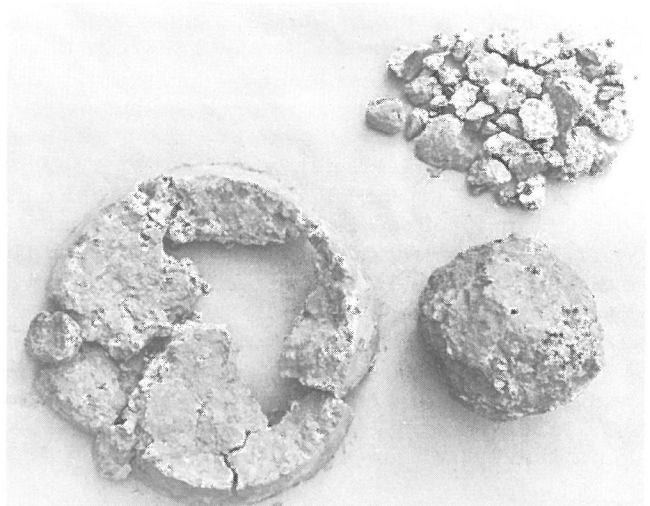
Bild 7 Vom Masseblock einer monolithischen Masse abgebröckelte Masseteile nach dem Fallversuch aus 70 cm Höhe nach ISO
