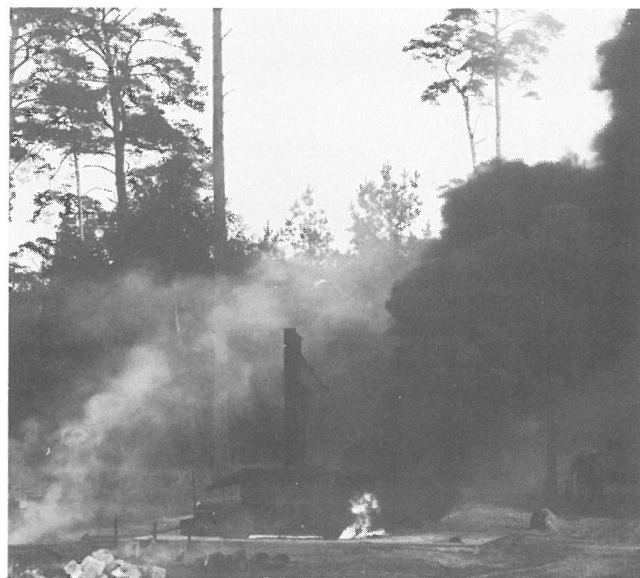
Bild 17 Zündversuchsstand etwa 1 Minute nach dem Bersten einer mit Acetylen überladenen Acetylenflasche
