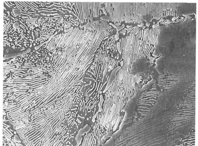
Bild 42 b Mikrogefüge der Probe Fe G 95.1 Perlit (rasterelektronenmikroskopisch)
