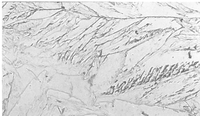
Bild 24 Probe Fe C 1.55 rekristallisiert, -196^{\circ}\text{C} , 1 h 500^{\circ}\text{C}
