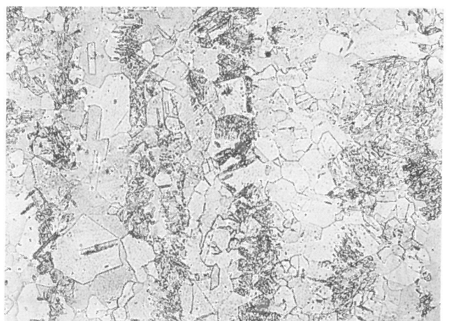
Bild 32 b Mikrogefüge der Probe Fe C 1.3 (Fe-30 Ni, rekristallisiert, - 70°C)
