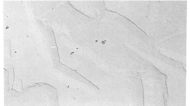
Bild 30 Probe Fe C 2.57 rekristallisiert, -196^{\circ}\text{C} , 1 h 750^{\circ}\text{C}
