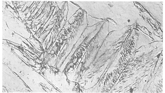
Bild 28 Probe Fe C 2.55 rekristallisiert, -196^{\circ}\text{C} , 1 h 500^{\circ}\text{C}
