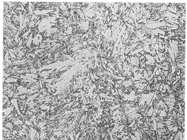
Bild 37 b Mikrogefüge der Probe Fe C 2.5 (Fe-30 Ni, rekristallisiert, -196^{\circ}\text{C} ) Vergr. 300 : 1
