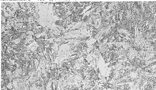
Bild 17 Probe Fe C 1.56 rekristallisiert, -196^{\circ}\text{C} , 1 h 650^{\circ}\text{C}
