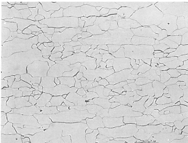
Bild 5 b Mikrogefüge der Probe Fe D 4 (Reineisen)
