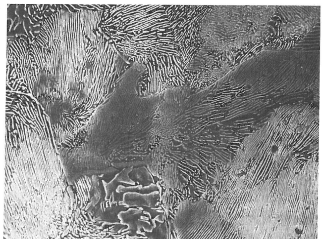
Bild 44 b Mikrogefüge der Probe Fe G 95.5 Perlit und Sorbit (rasterelektronenmikroskopisch)
