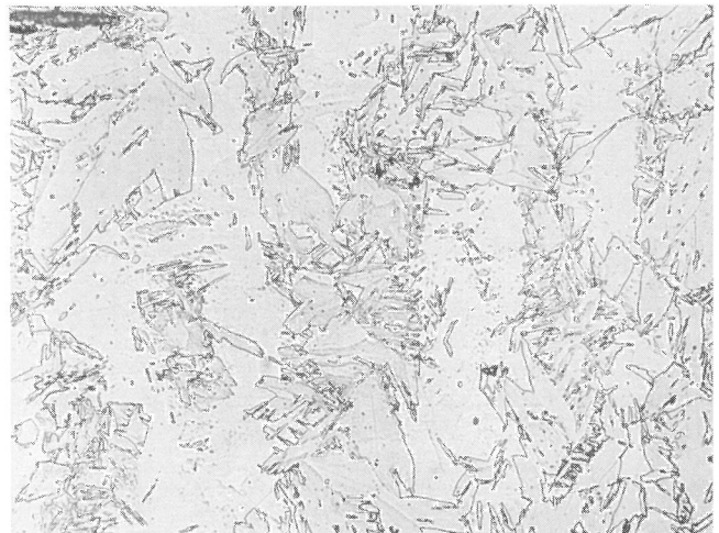
Bild 32 b Mikrogefüge der Probe Fe C 1.3 (Fe-30 Ni, rekristallisiert, - 70°C)
