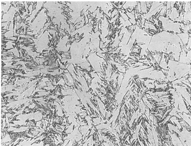
Bild 36 b Mikrogefüge der Probe Fe C 2.3 (Fe-30 Ni, rekristallisiert, -70^{\circ}\text{C} ) Vergr. 300 : 1
