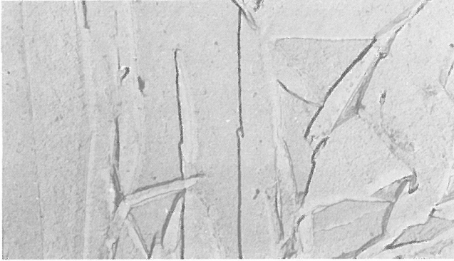
Bild 23 Probe Fe C 1.54 rekristallisiert, -196^{\circ}\text{C} , 1 h 400^{\circ}\text{C}
