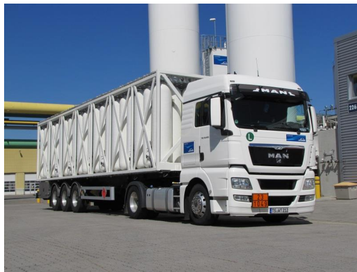
Abb. 13: Trailerfahrzeug zur Beförderung von Wasserstoff [51]
