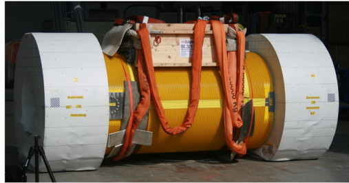
Abbildung 4.28: Fallversuchsanlage der BAM mit unnachgiebigem Fundament nach IAEA und Testbehälter der GNS in 9,3m Fallhöhe vor dem Fallversuch (links), Testbehälter der GNS nach dem Fallversuch (rechts)
