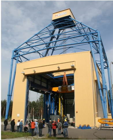
Abbildung 4.28: Fallversuchsanlage der BAM mit unnachgiebigem Fundament nach IAEA und Testbehälter der GNS in 9,3m Fallhöhe vor dem Fallversuch (links), Testbehälter der GNS nach dem Fallversuch (rechts)
