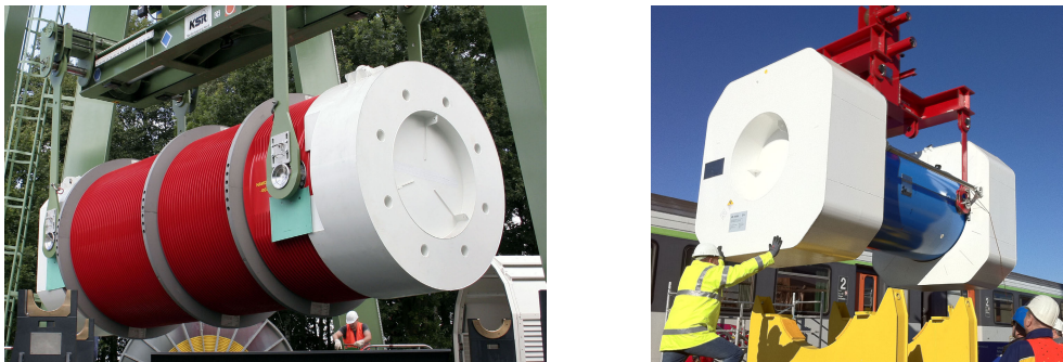
Abbildung 2.3: CASTOR ® HAW 28 M mit massiven Aluminium-Ringstoßdämpfern und blechummantelten Holzstoßdämpfern (links, Foto: GNS); CASTOR ® KNK mit blechummantelten Holzstoßdämpfern (rechts, Foto: DROSTE)
