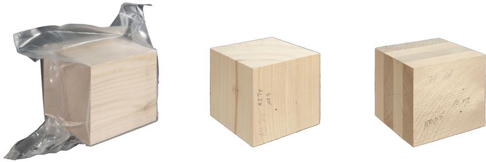
Abbildung 3.5: Fichtenholzproben der Kantenlänge 100 mm für die Druckversuche. In PVC-Folie eingeschweißte Probe (links), Probe für Lastorientierung parallel und senkrecht zur Faser (Mitte), Schichtholzprobe (rechts)
