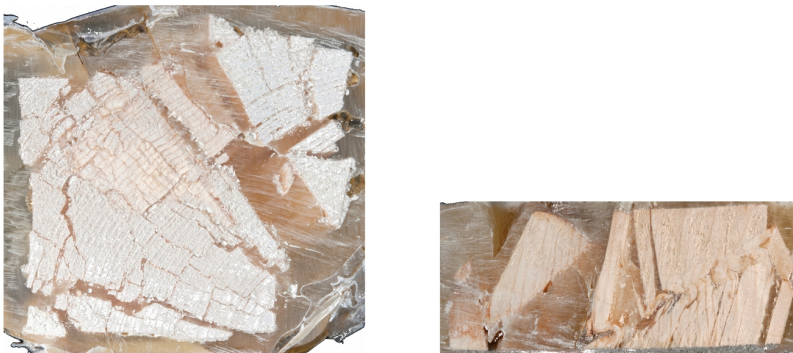
Abbildung 3.10: Schnittfläche einer mit Epoxidharz ausgegossenen Probe, belastet parallel zur Faser ohne Querdehnungsbehinderung, Stauchweg 20 mm. Links: Schnitt senkrecht zur Faserrichtung (untere Hälfte der Probe); rechts: Schnitt parallel zur Faserrichtung (obere Hälfte der Probe). Schnitt jeweils durch die Mitte der Probe
